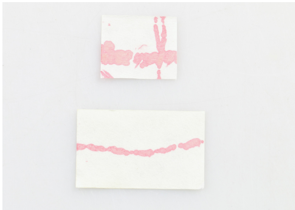
Obr. 149 Stav před restaurováním, pozitivní výsledek batofenantrolinového testu
