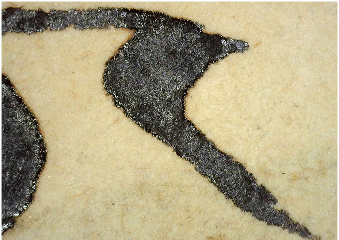
Obr. 181 Stav před restaurováním, pozorování pod zvětšením, vrstva železagalového inkoustu
