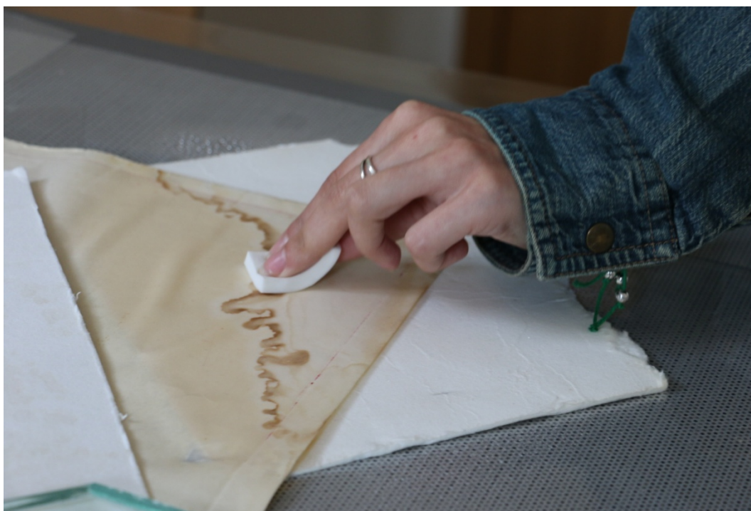
Obr. 20 Lokální čištění zatekliny na nízkotlakovém stole, čištění za použití bílé polyuretanové houbičky
