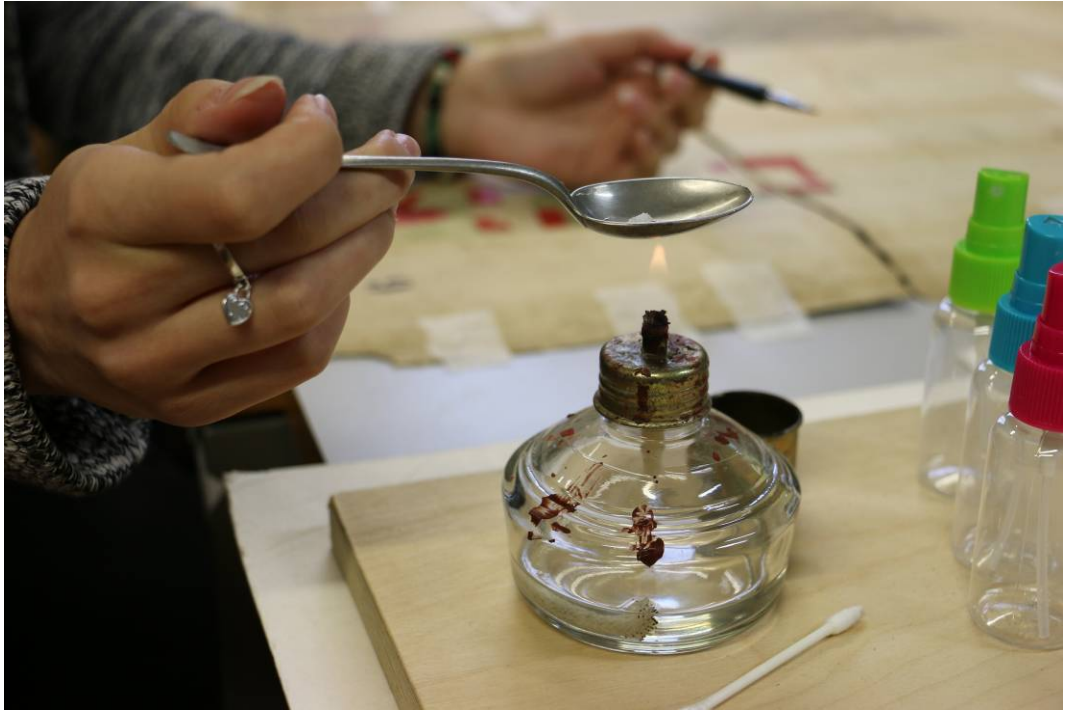
Obr. 34 Dočasná fixace barevné vrstvy taveninou cyklododekanu
