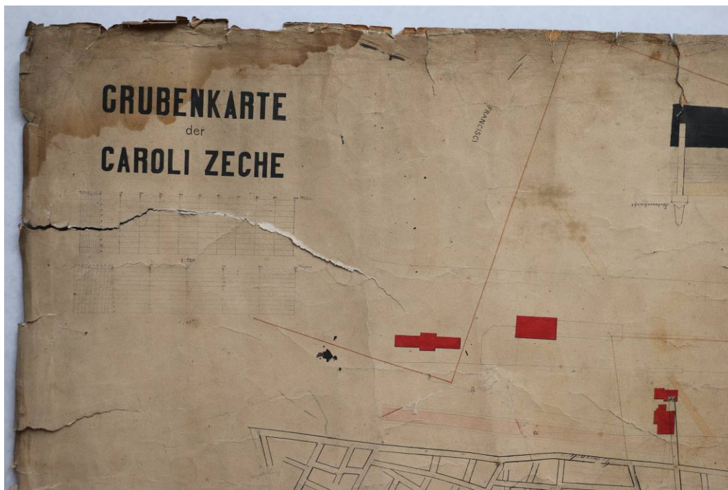
Obr. 3 Detail mechanického poškození v podobě trhlin, zateklin a ztráty papírové podložky, stav před restaurováním, líc
