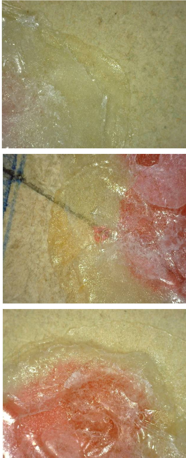
Obr. 36 Detail dočasná fixace barevné vrstvy taveninou cyklododekanu, Dino-Lite USB mikroskop
