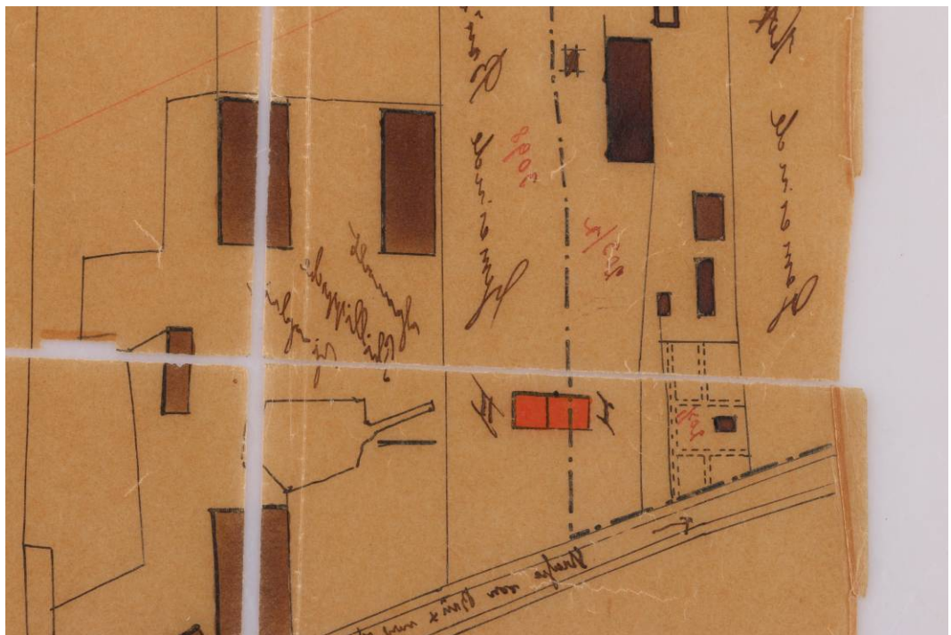
Obr. 4 Detail mechanického poškození v podobě trhlin a odření papírové podložky, stav před restaurováním, rub
