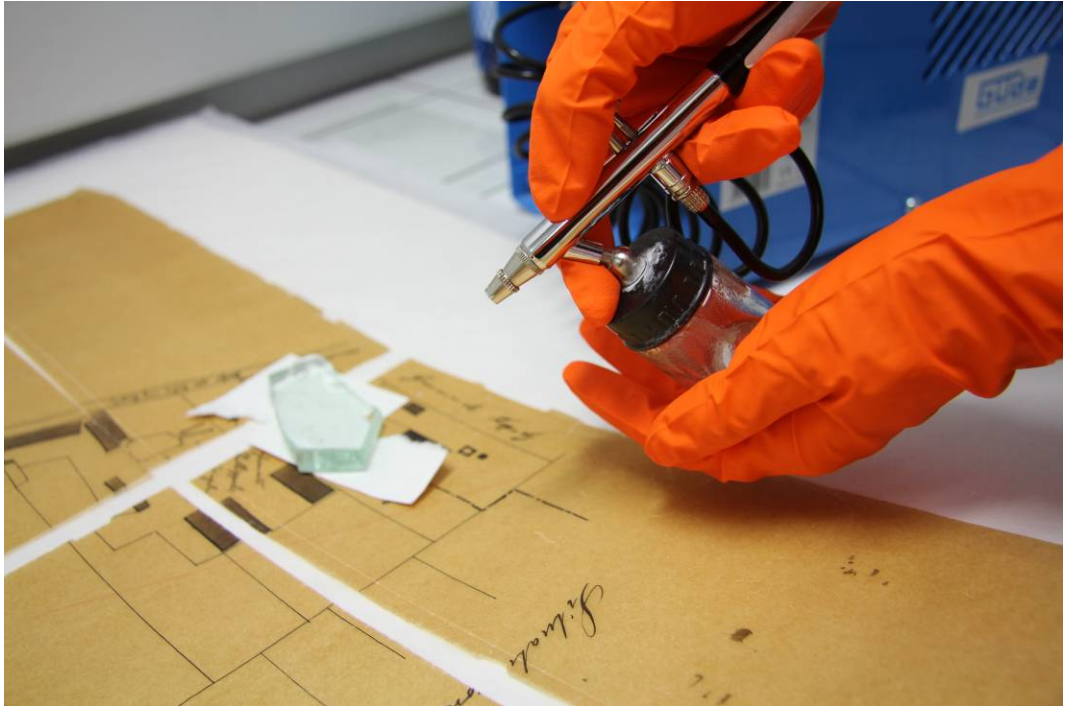
Obr. 13 Odkyselení papírové podložky 1% MMMK v methanolu aplikováno pomocí airbrush
