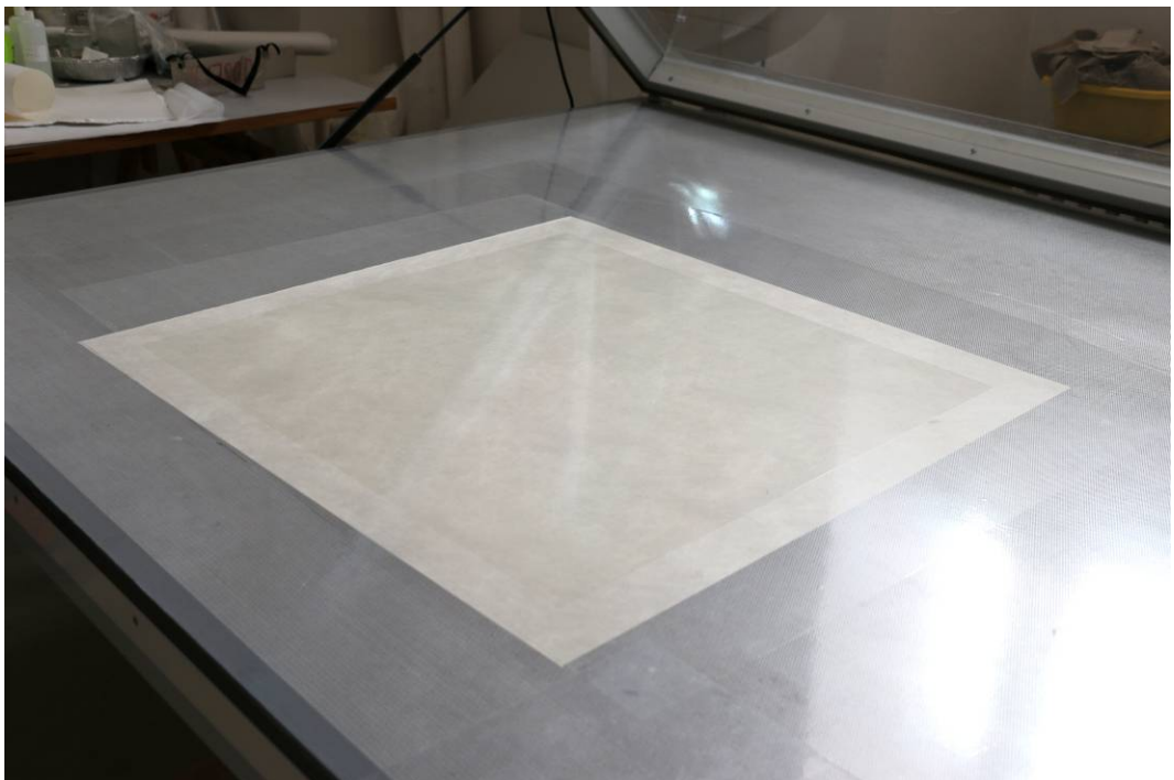
Obr. 14 Příprava podložky na tepelné laminování, fólie BEVA 371 film 25 \mu m a japonský papír Gampi 22 g/m 2
