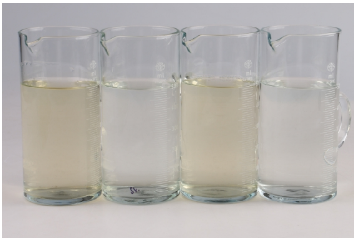
Obr. 62 Zkouška mokrého čištění – voda po koupání bez tenzidu (vlevo), s tenzidem (vpravo)
