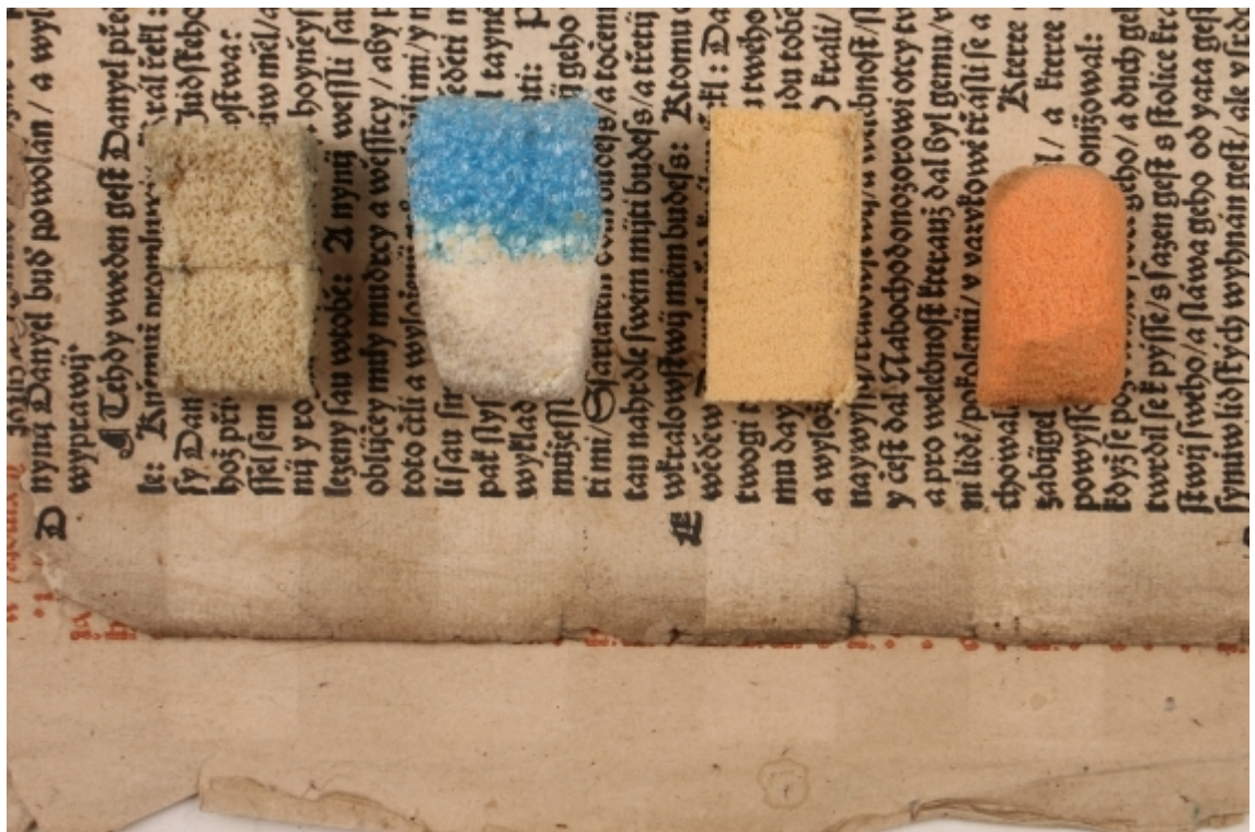
Obr. 59 Zkouška mechanického čištění různými typy gumy
