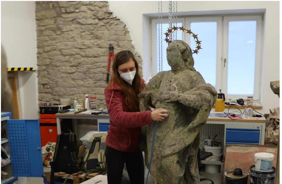
Obrázek 134 Měření ultrazvukové transmise na figuře
