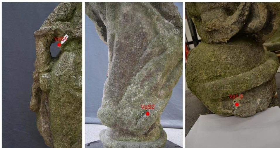
Obr. 2 a-c: Lokalizace míst odběru vzorků solných výkvětů VzS1 a VzS2 (vlevo a uprostřed) a vodorozpustných solí (Vz1-3). Foto: Z. Korábková.
