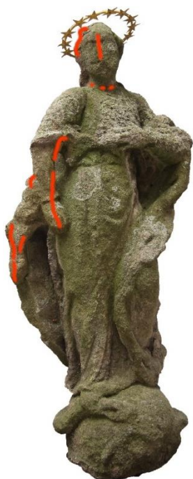
Obrázek 80 Vyznačené kovové prvky v materiálu
