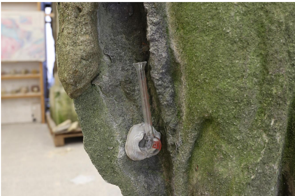
Obrázek 128 Měření nasákavosti, Karstenova trubice
