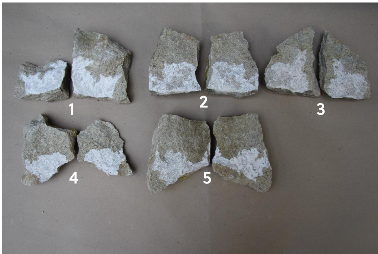
Obr. 40. Zkoušky injektážních směsí na Apollóna
