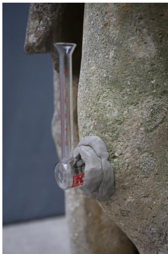
Obrázek 4 ilustrační fotografie měření kapilární absorpce
