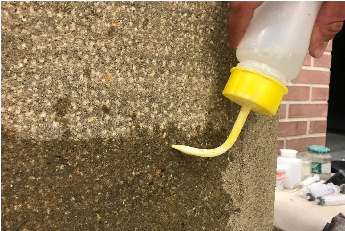
Obrázek 57 strukturální konsolidace podstavce organo-kremičitanem
