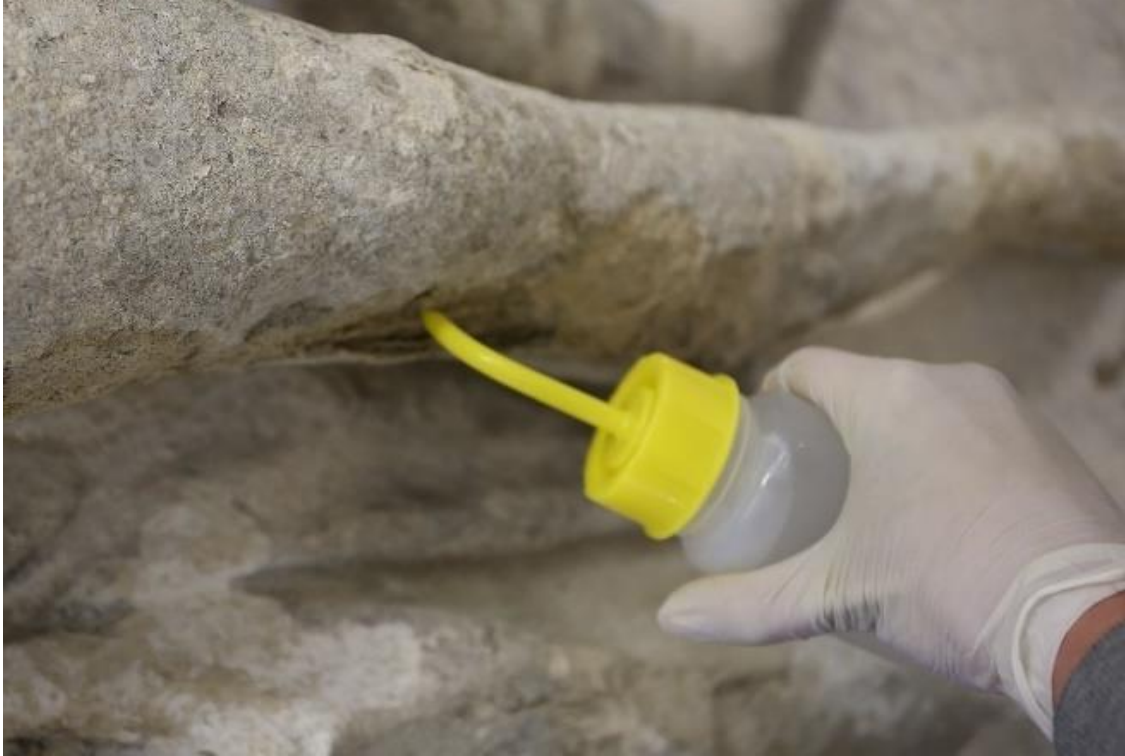
Obrázek 55 strukturální konsolidace sochy Apollóna organo-kremičitanem
