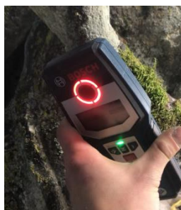
Obrázek 5 ilustrační fotografie lokalizace kovových armatur detektorem kovů (BOSCH GMS 120 Professional)
