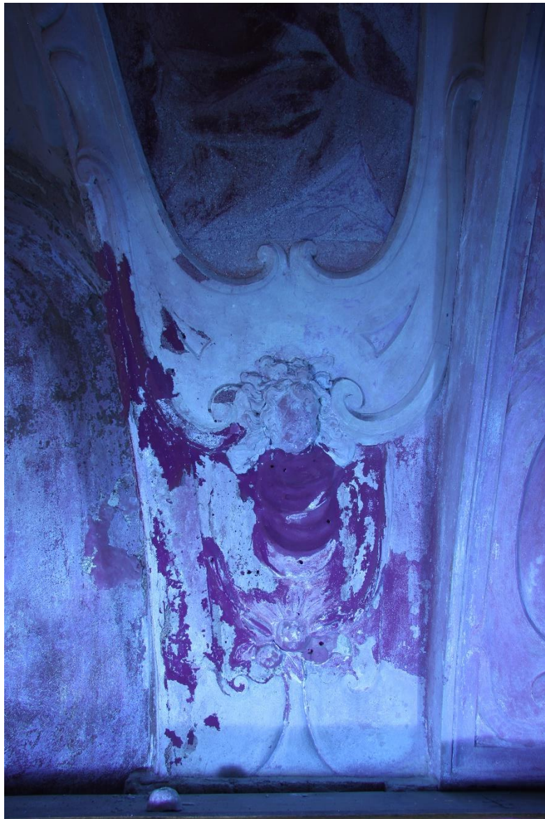
Obrázek 58 Vizuelní průzkum v UV světle – tmavěfialová luminiscence sádry a sádrových šlemů
