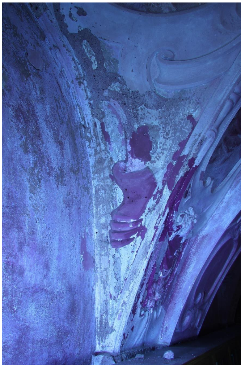
Obrázek 59 Vizuelní průzkum v UV světle – tmavě-fialová luminiscence sádry a sádrových šlemů
