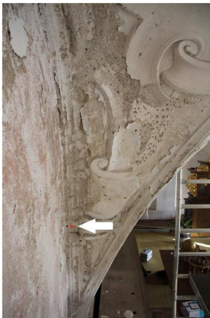
Obr. 40 Odběr vzorků V z vrtu provedeného kvůli stanovení obsahu vodorozpustných solí po odsolování.
