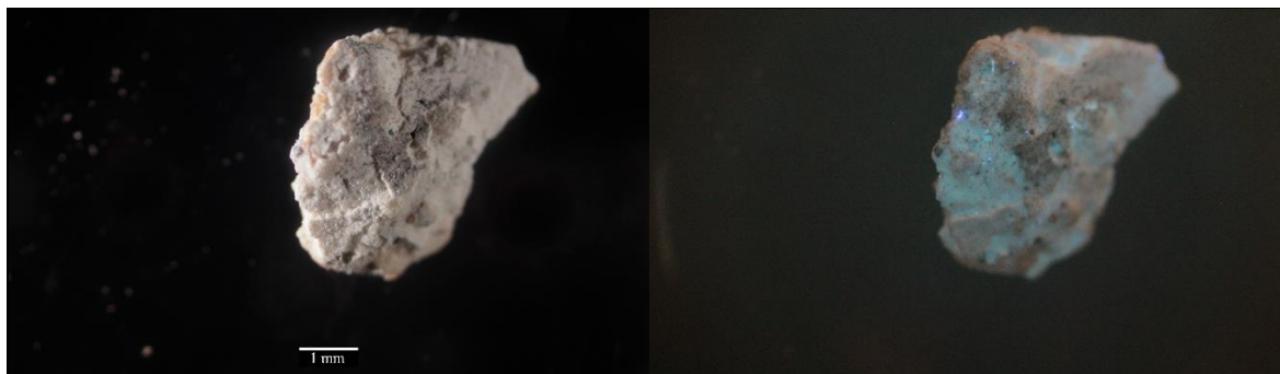
Obr. 157, 158 Optická mikroskopie, vzorek z pohledové strany, bílé světlo, UV luminiscence.
