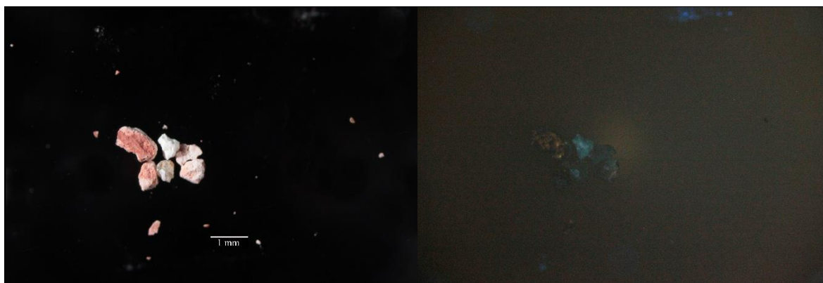
Obr. 86, 87 Optická mikroskopie, vzorek převážně z pohledové strany, bílé světlo, UV luminiscence.
