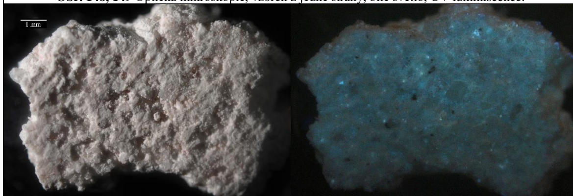
Obr. 150, 151 Optická mikroskopie, vzorek z druhé strany, bílé světlo, UV luminiscence.
