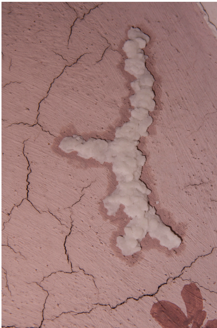
Obr. 42: Zkoušky čištění znečištěných prasklin. Zábál z buničiny Arbocel BC 200 . Stav během čištění.
