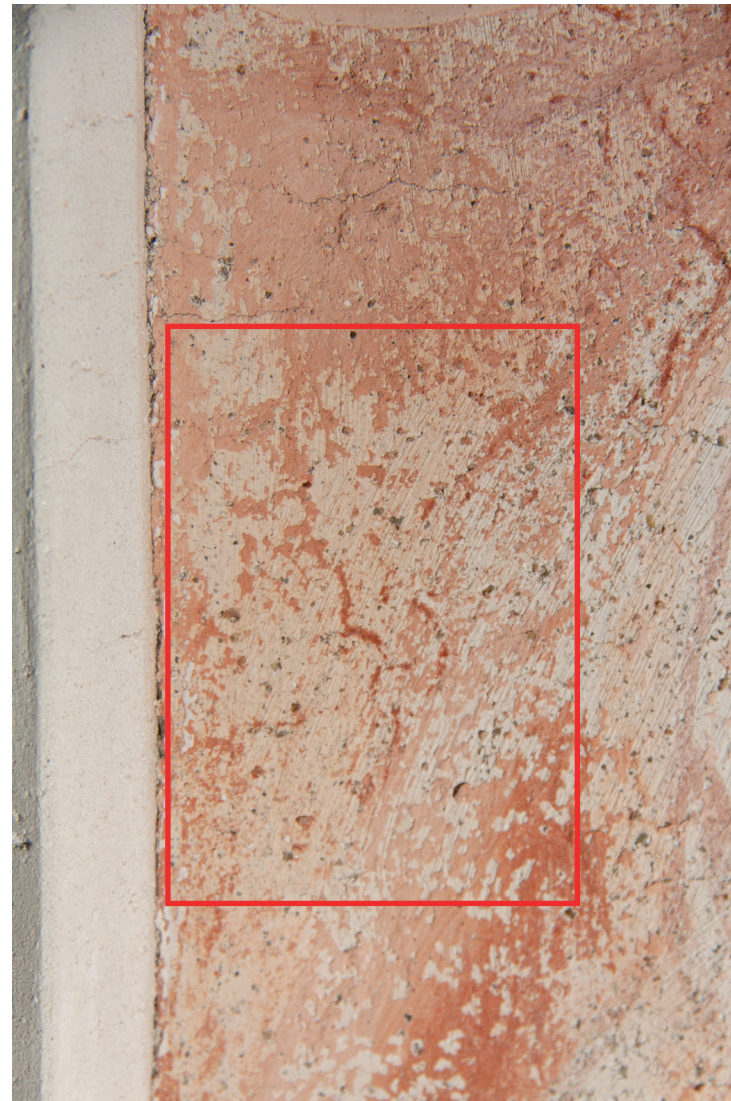
Obr. 37: Zkouška konsolidace zpráškovatělé barevné vrstvy vápennou nanosuspenzí CaLoSiL E25 v koncentraci 5 g/l. Stav po desátém cyklu aplikace.
