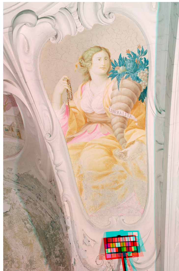
Obr. 32: Snímek IR reflektografie v takzvaných falešných barvách (IRRFC).
