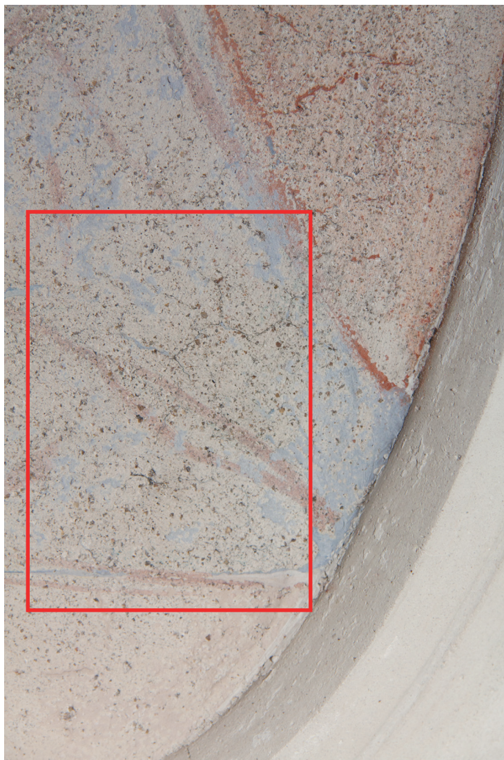
Obr. 38: Zkouška konsolidace zpráškovatělé barevné vrstvy vápennou nanosuspenzí CaLoSiL E25 v koncentraci 10 g/l. Stav po čtrnáctém cyklu aplikace.
