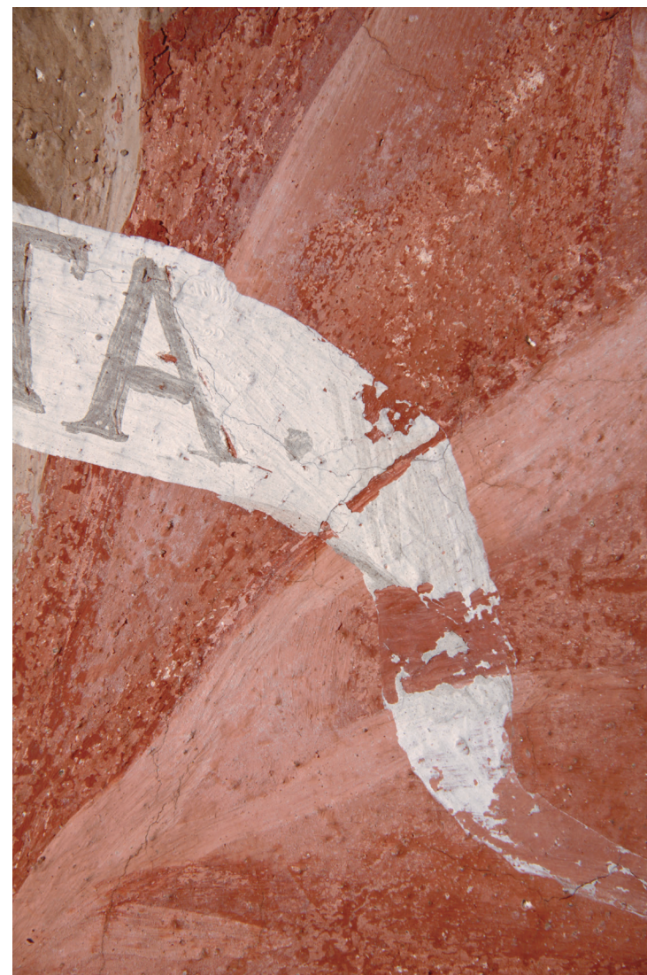
Obr. 39: Zkouška konsolidace šupin barevné vrstvy akrylátovou disperzí Dispersion K9 v 3% (hm.) koncentraci ve vodě.
