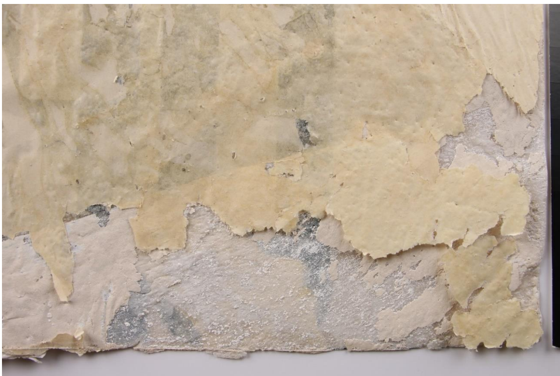
Fotografie č. 49 Detail poškození v levém spodním rohu s lepidlem mezi odštěpené vrstvy papíru po očištění od lepidla a omítky
