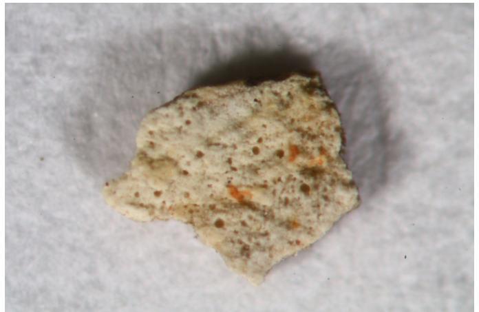
Obr. M9/01 a-b: Makrosnímek vzorku M9/10421 odebraný z nereidy na přilbici Marta. a) Snímek lícové a b) rubové strany vzorku s bílým štukovým podkladem. Snímky v odraženém světle na stereomikroskopu SMZ 800 (Nikon). Foto: R. Tišlová. Podklad tvoří bílá až sv. okrová vrstva viditelným obsahem oválných makropórů.
