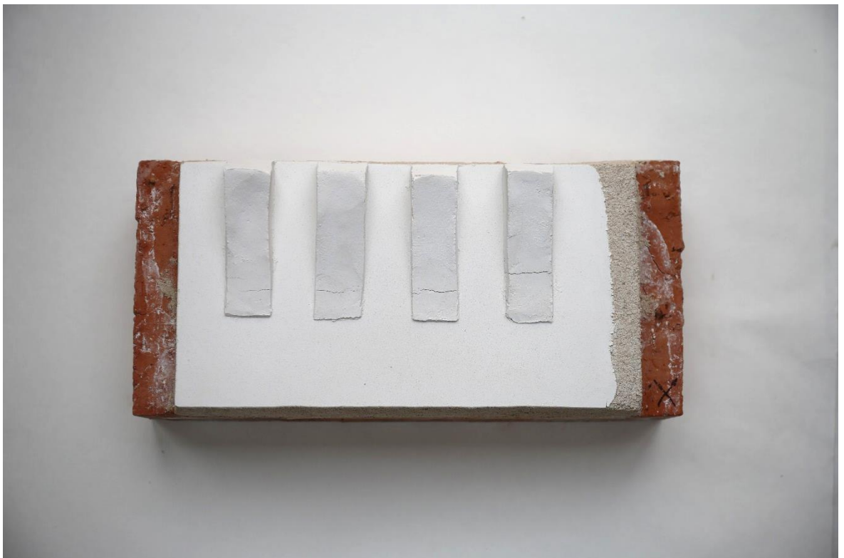
Obr. č. 122 Vzorčky štukových směsí připravené z vápenné kaše z vilémovického vápence z lomu Mokra (zprava do leva) receptury 2:1, 1,5:1, 1:1, 1:1,5 (poměr pojiva: plniva, obj. dílu)
