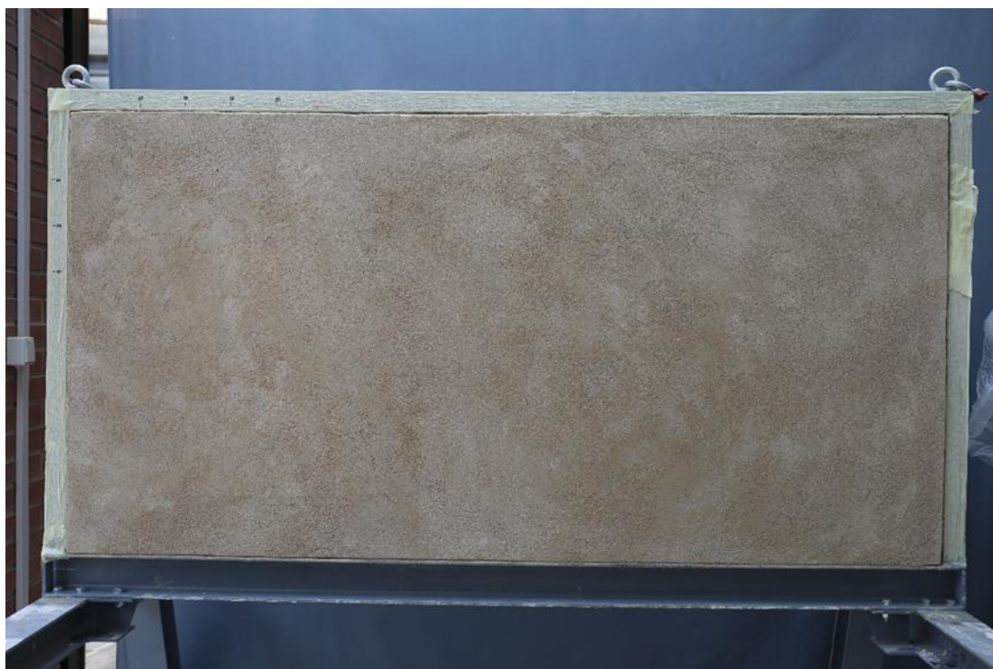
Obr. č. 216 Podkladová vrstva ariccia
