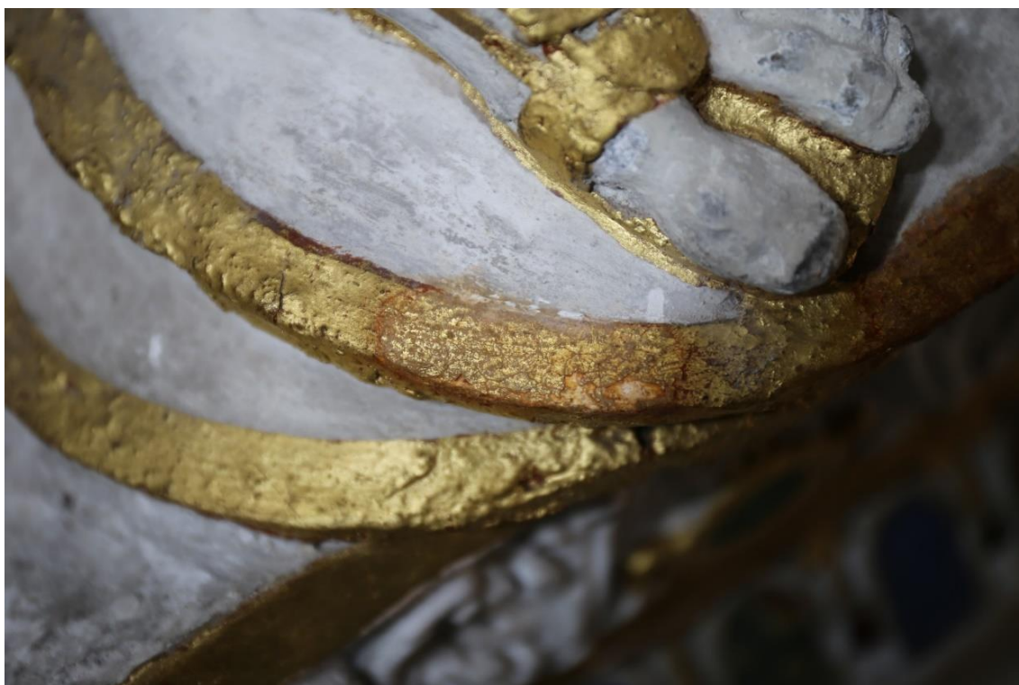
Obr. č. 161 Výsledek zkoušky odstranění sekundárního zlácení
