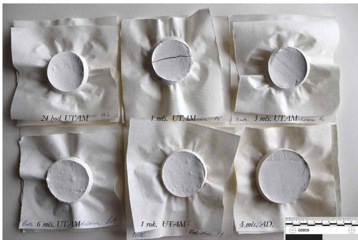
Obr. č. 119 Rozměrová stabilita vápenné kaše z nedvědickeho mramoru
