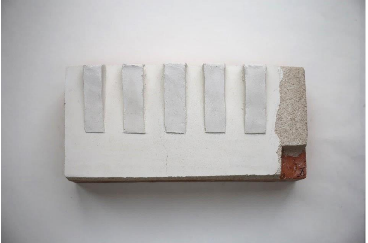
Obr. č. 121 Vzorčky štukových směsí připravené z vápenné kaše ze sliveneckého vápence (Zprava do leva) receptury 2:1, 1,5:1, 1:1, 1:1,5, 1:2 (poměr pojiva: plniva, obj. d)
