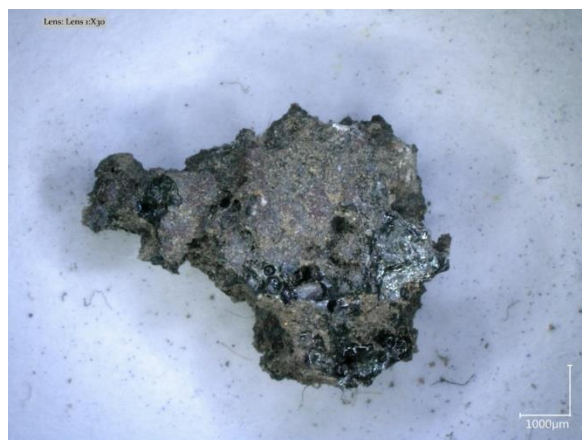
Obr. č. 14 Makrofotografie metalurgické strusky použité jako výplň při budování objemů štukové výzdoby. Vzorek pochází ze strusky vložené do štuky při vytváření modelace kanonu. Foto: Peter Majoroš
