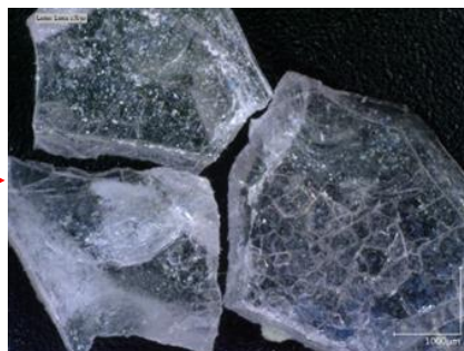
Obr. č. 19 Fragmentace důsledkem chemické degradace
