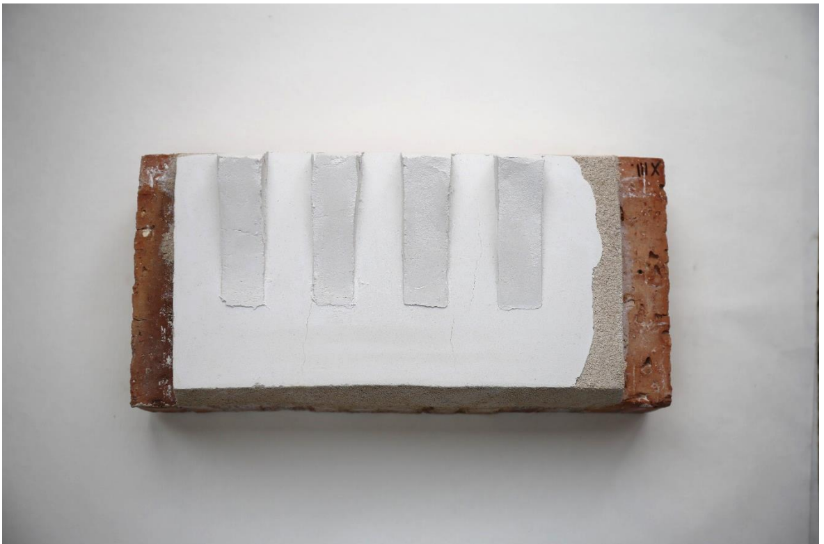
Obr. č. 124 Vzorčky štukových směsí připravené z vápenné kaše z nedvědicového mramoru (z prava do leva) receptury 2:1, 1,5:1, 1:1, 1:1,5 (poměr pojiva: plniva, obj. dílů)
