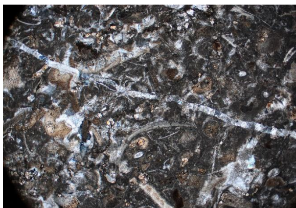
Obr. č. 111 Slivenecký vápenec – našedlá oblast. Zvětšení na mikroskopu 2x. Snímek XPL.
