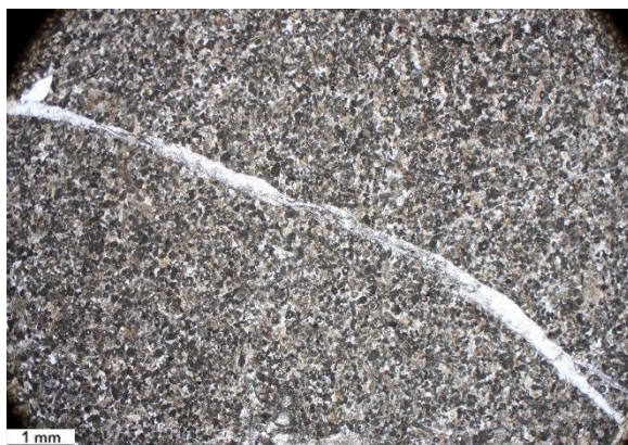
Obr. č. 107 Vilémovický vápenec z lomu Mokrý. Zvětšení na mikroskopu 2x. Snímek PPL.
