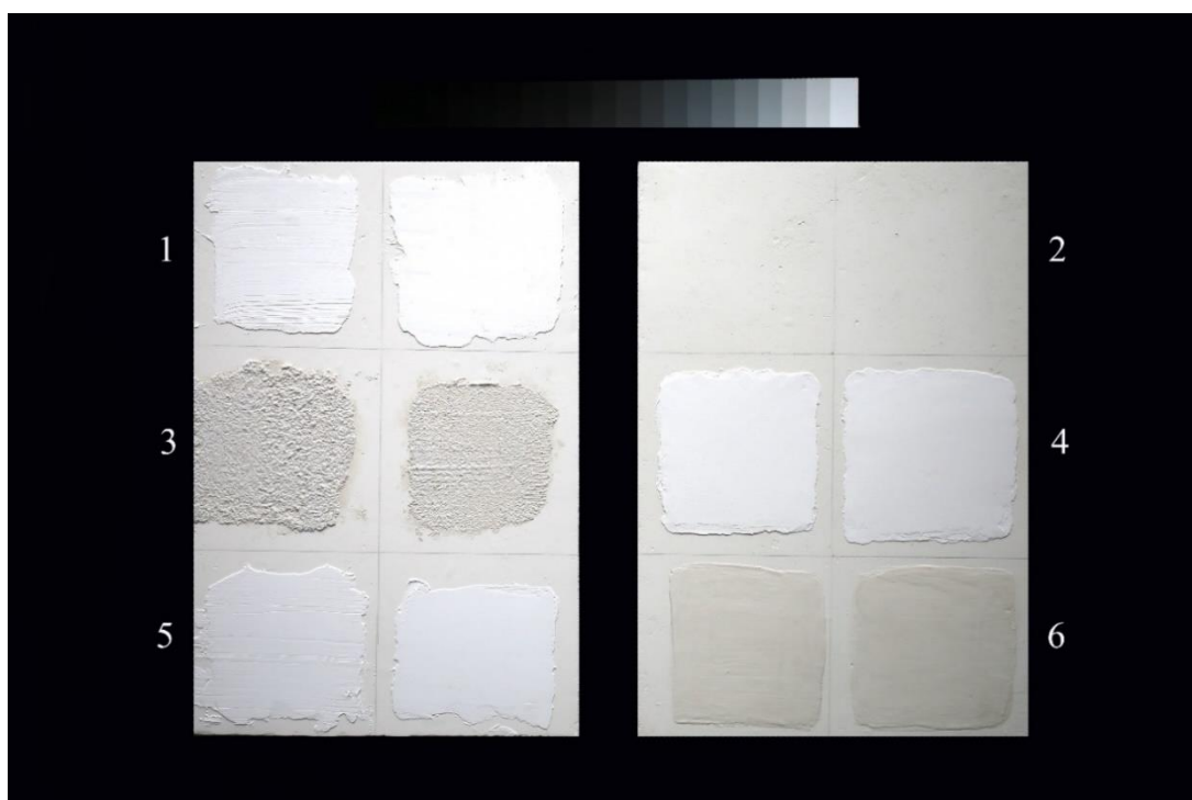
Obr. č. 40 Modostuc (1), želatina 7% + šampaňská křída (2), Biva Gesso (3), HB Lak akrylátový tmel (4), Italstucco (5), Aquazol 500 15% + šampaňská křída (6)
