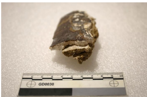
Obr. č. 11 Fotografie štukového fragmentu uvolněného při restaurování kanonu. Na fotografii jsou patrné dvě modelační vrstvy (tloušťka od 7-10 mm). Finální modelační vrstva v bílém štuku marmorino nanášena v tloušťce 5-7 mm. Foto: Peter Majoroš
