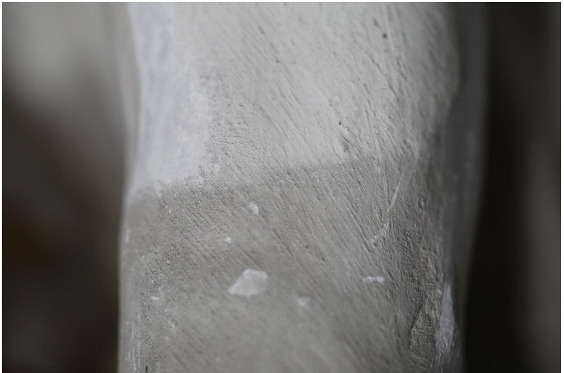
Obr. č. 157 Zkouška čištění volných a vázaných depozitů na povrchu plastiky Marta. Suchá mechanická cesta.
