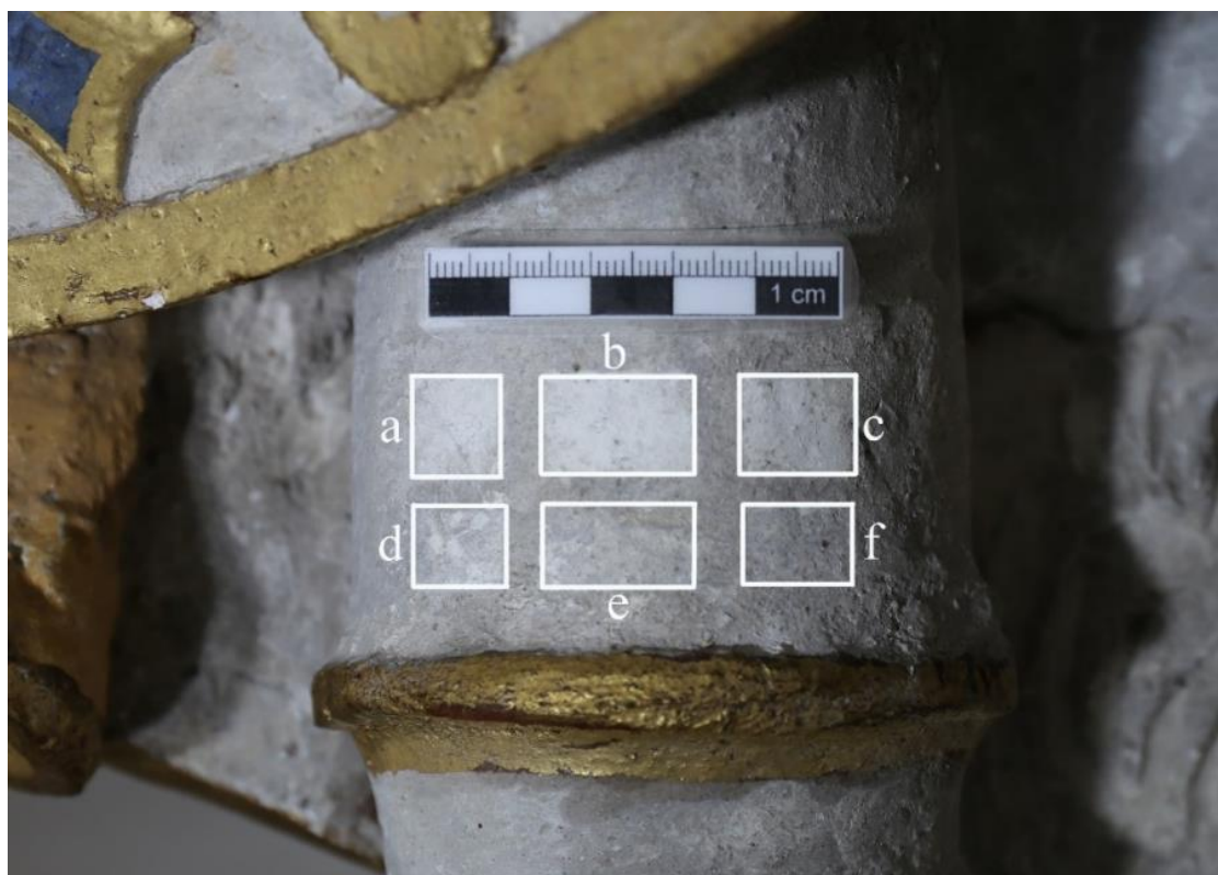
Obr. č. 28 Lokalizace provedených zkoušek odstraňování vápenných nátěrů. Označena pole a.) 8% EDTA, b.) 8% kyselina citronová, c.) 6,5% citrát diamonný, d.) isopropanol 99,9 %, e.) čistící štětec, f.) skalpel
