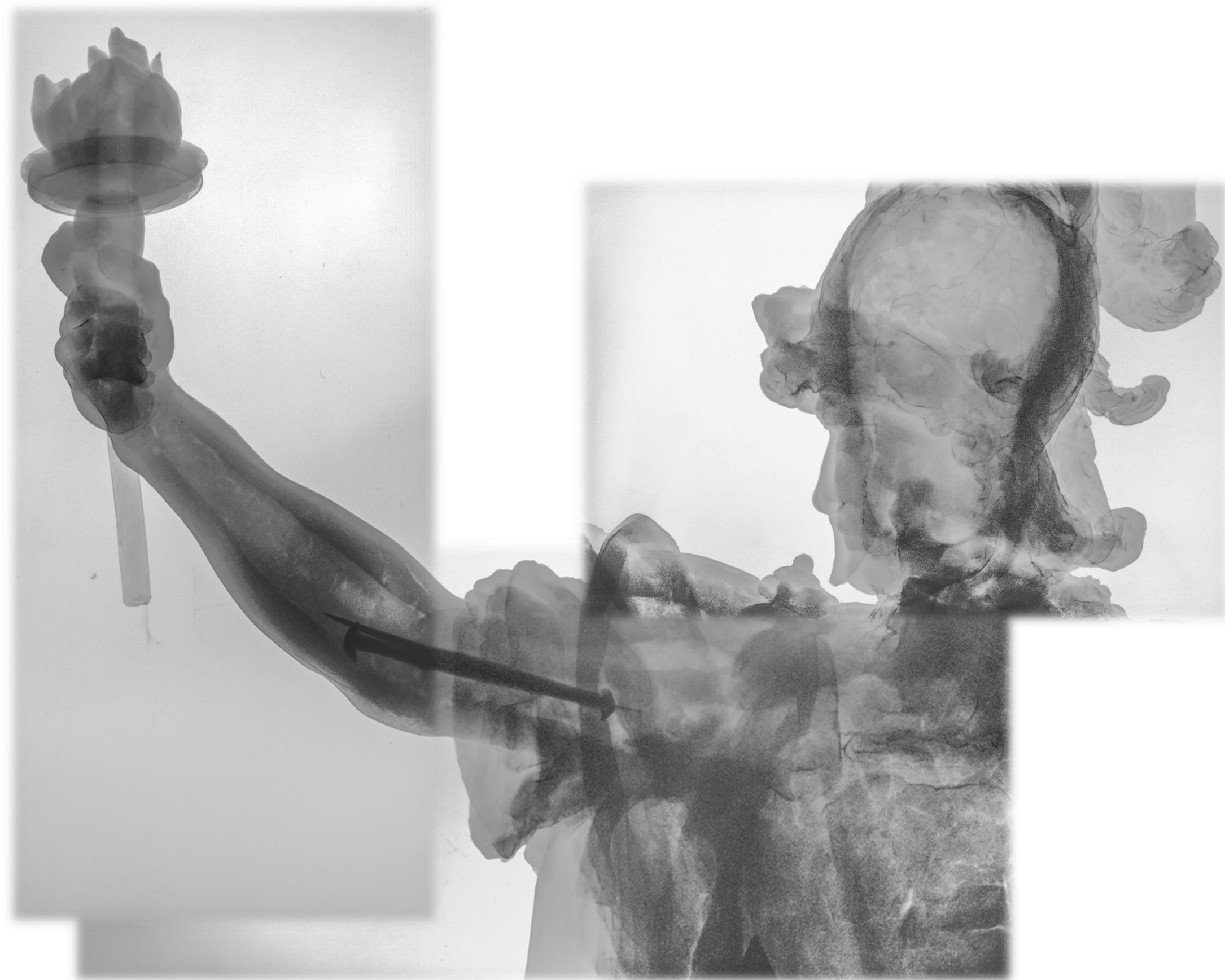
Obr. č. 133 Průzkum pomocí mobilní radiografie RTG/X-Ray. Průzkum provedl Jaroslav Valach (UTAM), Vizualizace: Peter Majoroš
