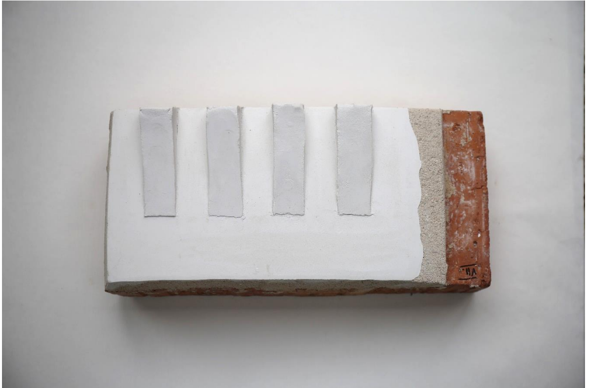
Obr. č. 123 Vzorčky štukových směsí připravené z vápenné kaše z koněpruského vápence (z prava do leva) receptury 2:1, 1,5:1, 1:1, 1:1,5 (poměr pojiva: plniva, obj. dílů)
