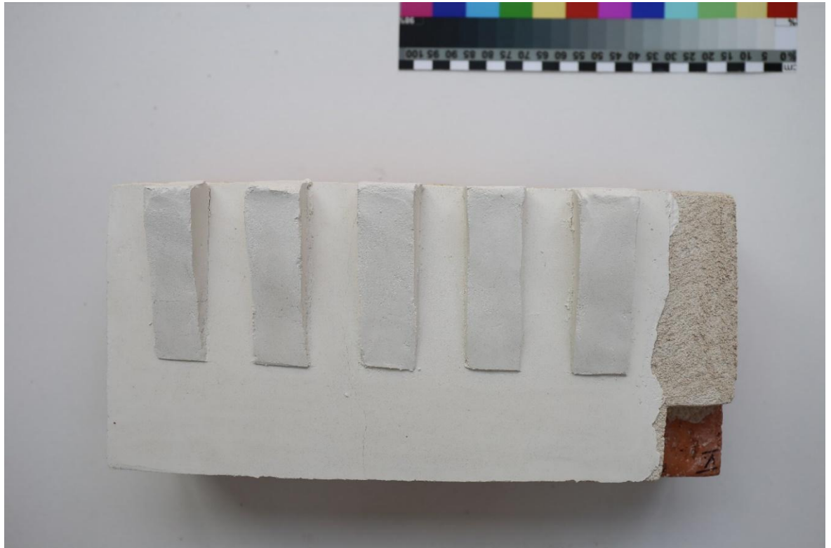
Obr. č. 97 Ateliérové testy štukových směsí (leva do prava poměr pojiva/plniva 2:1, 1,5:1, 1:1, 1:1,5, 1:2)
