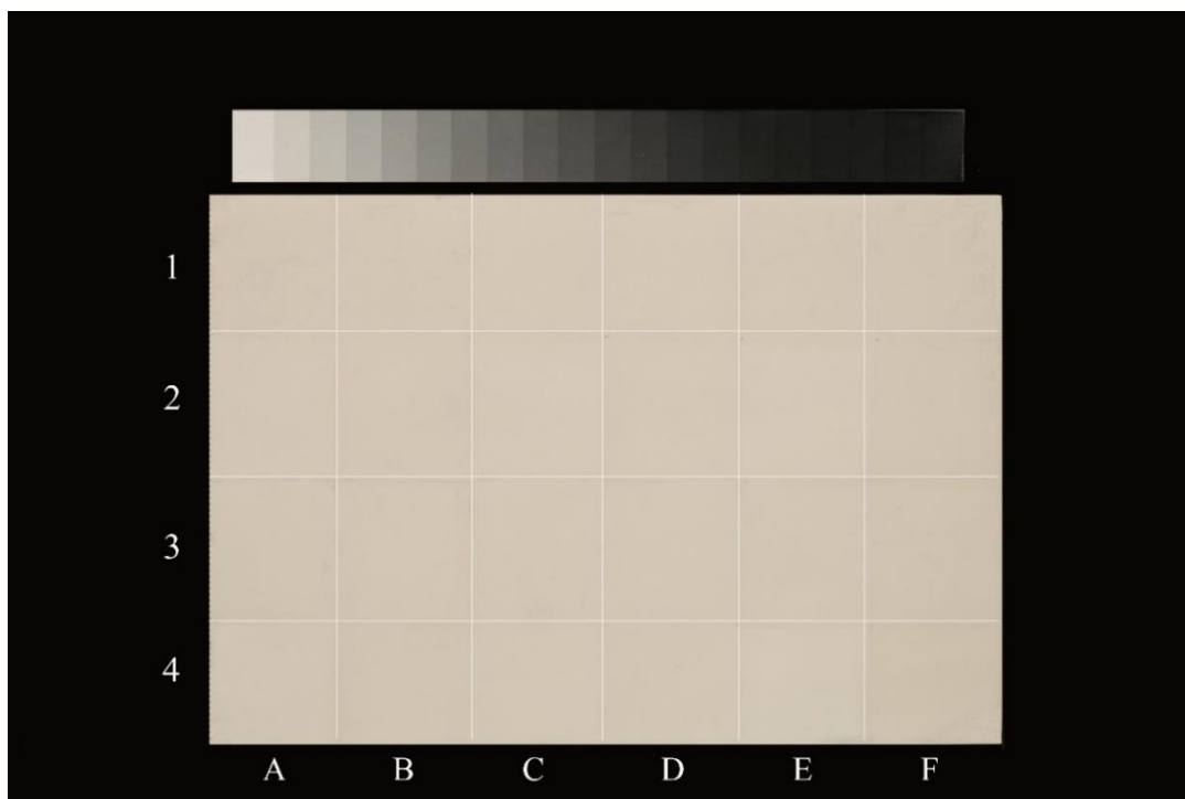
Obr. č. 35 Testovací terakotová deska s naneseným klišo-křídovým podkladem. Vyznačená pole po aplikaci konsolidantů.
