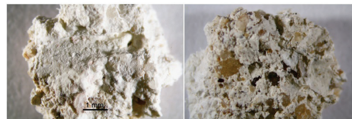
Obr. 52 a, b: Makrosnímek vzorku V10 (10035) z líčové (a) a rubové strany (b) vzorku. Snímek v odraženém bílém světle ze stereomikroskopu SMZ800 (Nikon) při zvětšení na mikroskopu 1,5x.
