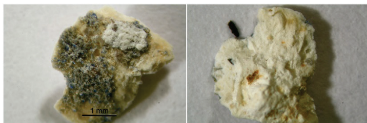
Obr. 7 a, b: Makrosnímek vzorku V2 (9882) z lícové (a) a rubové strany (b) vzorku. Snímek v odraženém bílém světle ze stereomikroskopu SMZ800 (Nikon) při zvětšení na mikroskopu 3x.
