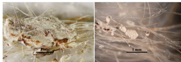
Obr. 50: Makrosnímek vzorku V22 (10178) z líčové strany vzorku (vlevo) a detail vláken (vpravo). Snímek v odraženém bílém světle ze stereomikroskopu SMZ800 (Nikon) při zvětšení na mikroskopu 2x a 5x. Vlevo detail štuků se zbytky dochované polychromie v růžové a hnědo-červené barevnosti.
