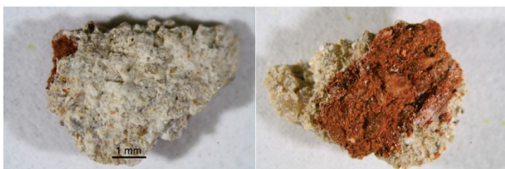
Obr. 24 a, b: Makrosnímek vzorku V7 (10032) z líčové (a) a rubové strany (b) vzorku. Snímek v odraženém bílém světle ze stereomikroskopu SMZ800 (Nikon) při zvětšení na mikroskopu 1,5x. Červená vrstva je cihlový podklad.
