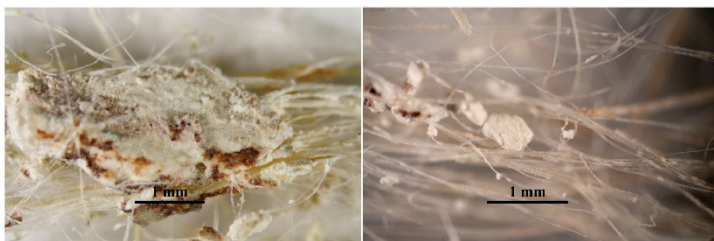
Obr. 59: Makrosnímek vzorku V22 (10178) z líčové strany vzorku (vlevo) a detail vláken (vpravo). Snímek v odraženém bílém světle ze stereomikroskopu SMZ800 (Nikon) při zvětšení na mikroskopu 2x a 5x.
