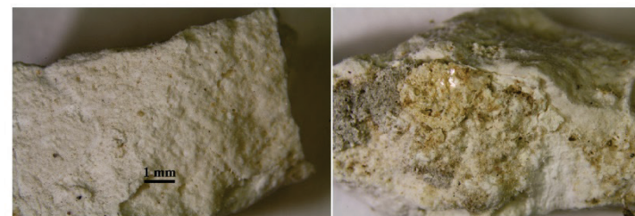
Obr. 38 a, b: Makrosnímek vzorku V16 (10172) z licové (a) a rubové strany (b) vzorku. Snímek v odraženém bílém světle ze stereomikroskopu SMZ800 (Nikon) při zvětšení na mikroskopu 1x.
