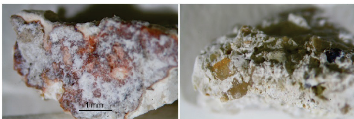
Obr. 19 a, b: Makrosnímek vzorku V5A (9933) z lícove (a) a rubové strany (b) vzorku. Snímek v odraženém bílém světle ze stereomikroskopu SMZ800 (Nikon) při zvětšení na mikroskopu 2x.
