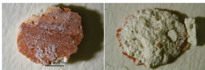
Obř. 5 a, b: Makrosnímek vzorku VIA (9931) z lícové (a) a rubové (b) strany vzorku. Snímek v odraženém bílém světle ze stereomikroskopu SMZ800 (Nikon) při zvětšení na mikroskopu 2x. Na povrchu vzorku se nachází zbytky překryvných bílých nátěrů, které nejsou předmětem analýzy.
