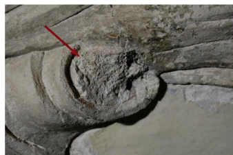
Obr. 10: Detail místa odběru vzorku V10. Pravá ruka anděla vlevo, v místě defektu, souvrství modelační a jádrové vrstvy štku.
