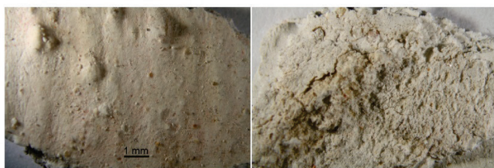
Obr. 29 a, b: Makrosnímek vzorku V9 (10034) z líčové (a) a rubové strany (b) vzorku. Snímek v odraženém bílém světle ze stereomikroskopu SMZ800 (Nikon) při zvětšení na mikroskopu 1x.
