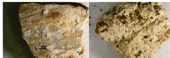
Obr. 46 a, b: Makrosnímek vzorku V20 (10176) z lícové (a) a rubové strany (b) vzorku. Snímek v odraženém bílém světle ze stereomikroskopu SMZ800 (Nikon) při zvětšení na mikroskopu 1x.
