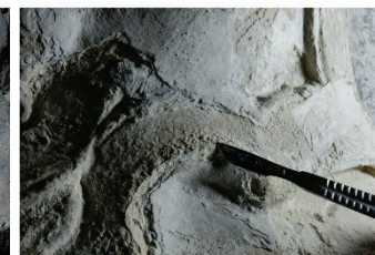
Obr. 14: Detail místa odběru vzorku V14 (S1) pro chemicko-technologický průzkum. Přilba, seškrab solných vykvětů na sekundárním dopltku.
