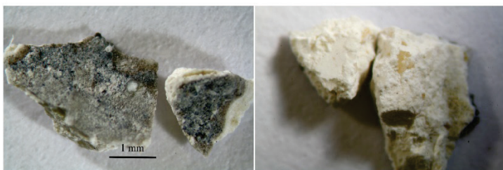
Obr. 17 a, b: Makrosnímek vzorku V5 (9885) z lícové (a) a rubové strany vzorku (b). Snímek v odraženém bílém světle ze stereomikroskopu SMZ800 (Nikon) při zvětšení na mikroskopu 2x.
