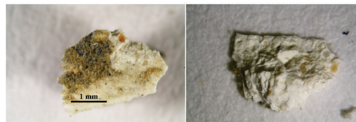
Obr. 42 a, b: Makrosnímek vzorku V18 (10174) z licové (a) a rubové strany (b) vzorku. Snímek v odraženém bílém světle ze stereomikroskopu SMZ800 (Nikon) při zvětšení na mikroskopu 2x.
