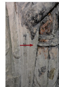
Obr. 6 a, b: Detail místa odběru vzorku V6 pro chemicko-technologický průzkum. Šeďový výjev epitafru, druhá figura zleva, kabátec staršího syna, ztvrdlá vrstva druhotných nátěrů.
