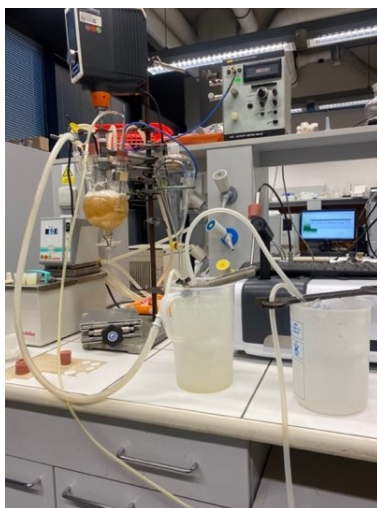
Obrázek 12: Aparatura vakuové destilace s vymražením butanolu
