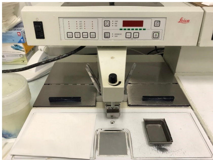
Obrázek 6: Přístroj pro zalévání vzorku tkáně a následný vznik mega bloků
