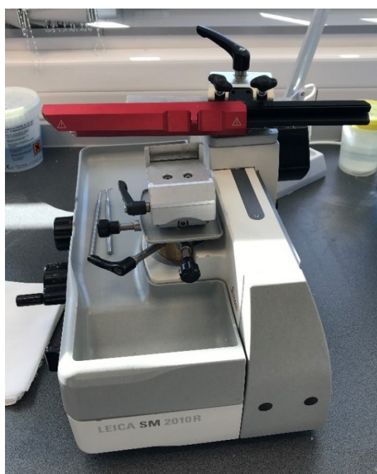
Obrázek 8: Sáňkový mikrotom Leica
