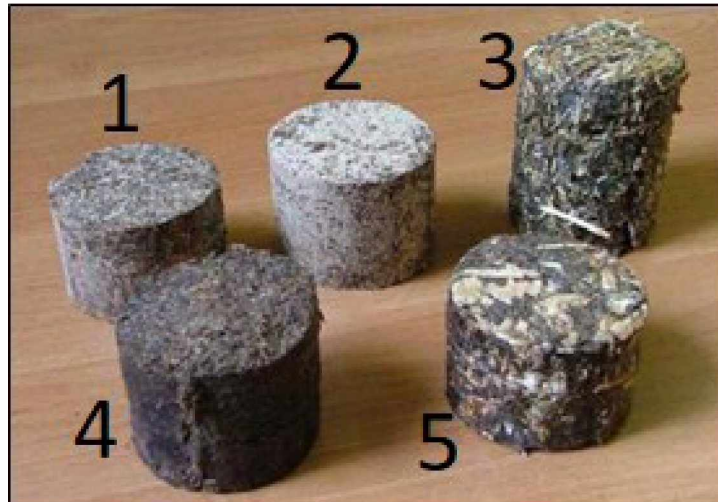
Obrázek 8 - Brikety ze separátu a biomasy, 1 – separát s dřevěnými pilinami 1:1, 2 - separát s dřevěnými pilinami 3:7, 3 - separát s senem 1:1, 4 - čistý separát, 5 - separát s topolovou štěpkou 1:1 [61] (upraveno)
