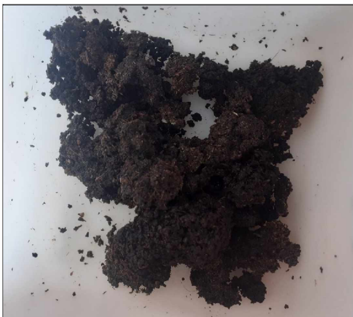
Obrázek 13 - Gel s poměry 7 g 1702TWA a 3,6 g 702TWB na 50 g fugátu (Foto autor)
