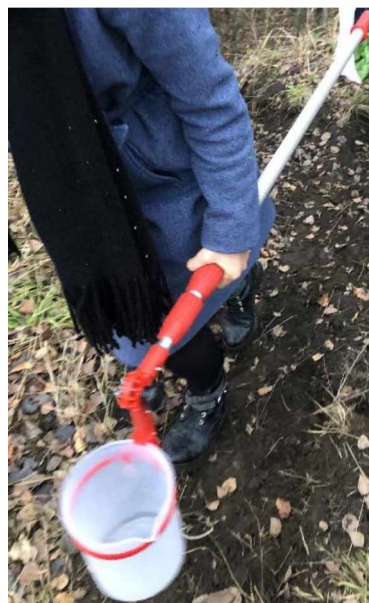
Obrázek 7: Teleskopický vzorkovač pro odběr povrchových vod (foto: vlastní)
