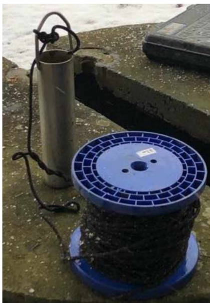
Obrázek 8: Trubkový hloubkový vzorkovač pro odběr podpovrchových vod (foto: vlastní)
