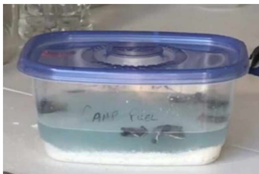
Obrázek 6 – Možné provedení one-pot reakce podle experimentu a studie A. Ciesielskeho. [14 p. 30]
