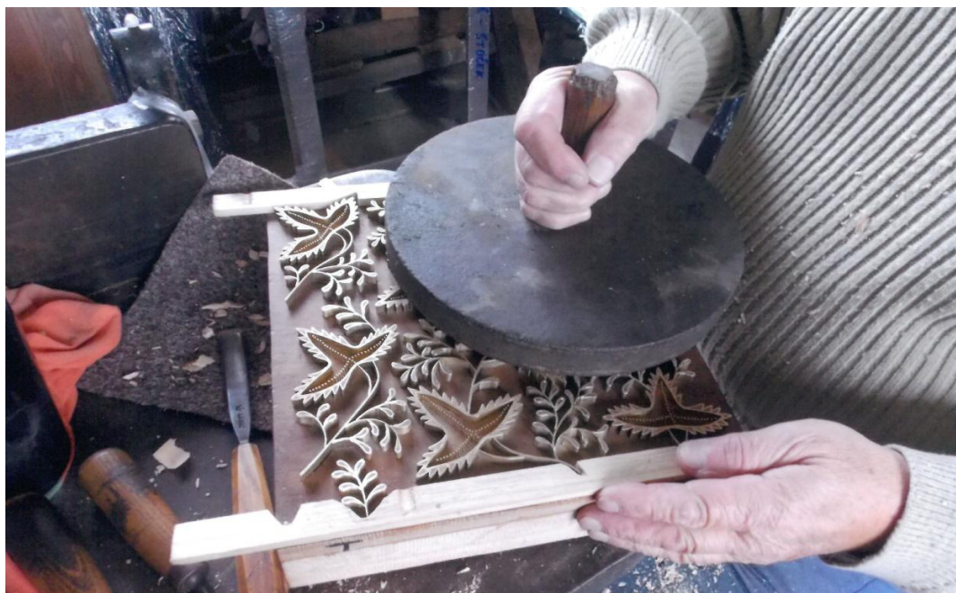
Obrázek 47 – Postup výroby formy podle Jaroslava Pluchy. Jedna z konečných úprav – zbroušení. 752
