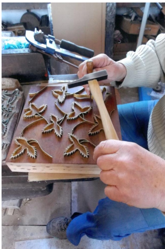
Obrázek 45 – Postup výroby formy podle Jaroslavy Pluchy. Zatloukání měděného plíšku. 750
