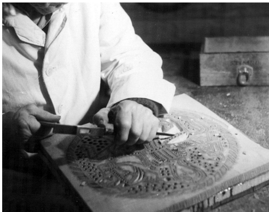
Obrázek 41 – Dochovaný postup výroby formy podle Josefa Vlka. Vyřezávání formy. 746
