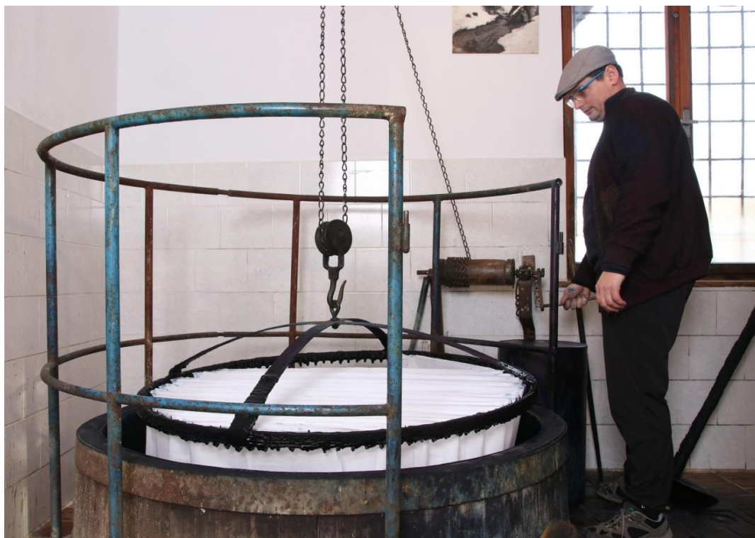
Obrázek 19 – Textilie navěšená na železnou hvězdu s háčky se noří do kypy s indigovým roztokem. 724
