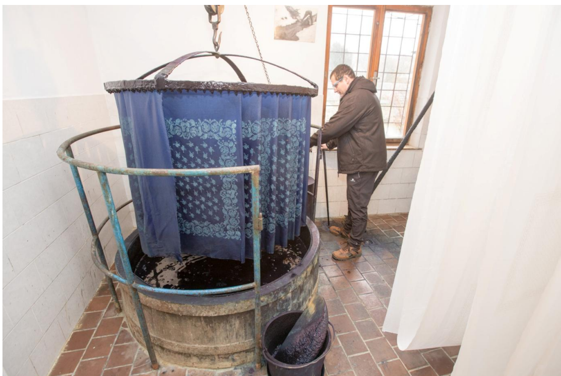
Obrázek 20 – Postup výroby modro bílé látky. Vytahování látky, která se oxidací zbarví do modra. 725
