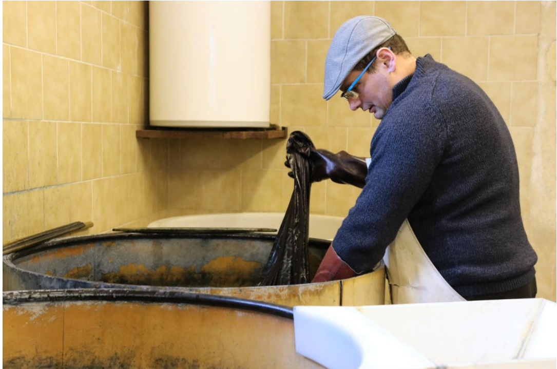
Obrázek 21 – Postup výroby modro bílé látky. Vyprání (máchání) obarvené látky v slabém roztoku kyseliny sírové. 726
