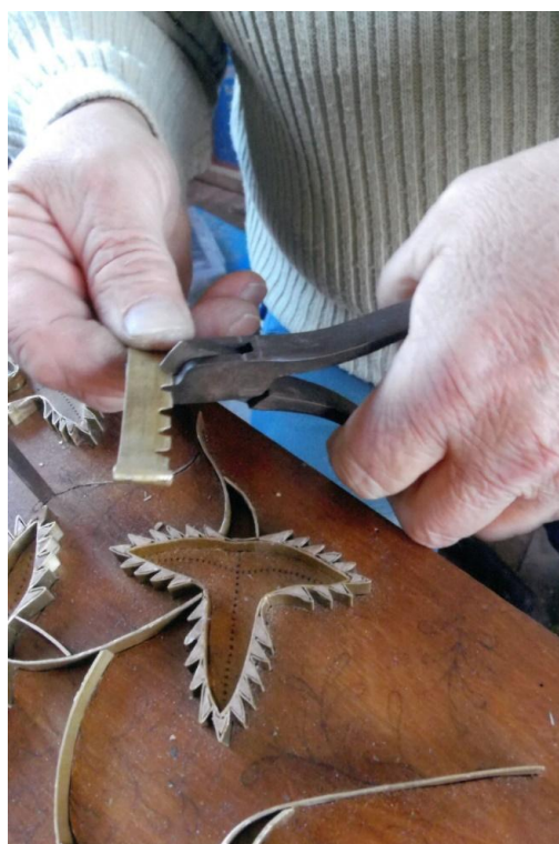
Obrázek 44 – Postup výroby formy podle Jaroslavy Pluchy. Vystřížení měděného plíšku. 749
