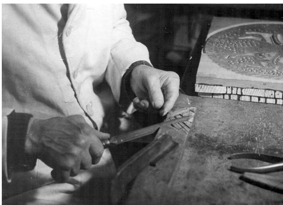
Obrázek 42 – Dochovaný postup výroby formy podle Josefa Vlka. Příprava měděného drátku. 747
