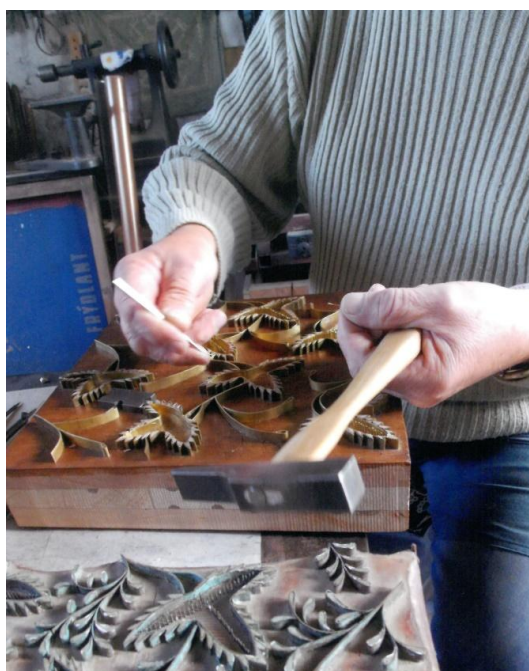
Obrázek 46 – Postup výroby formy podle Jaroslavy Pluchy. Doplnování dřevěných výplní do řasených lístků. 751
