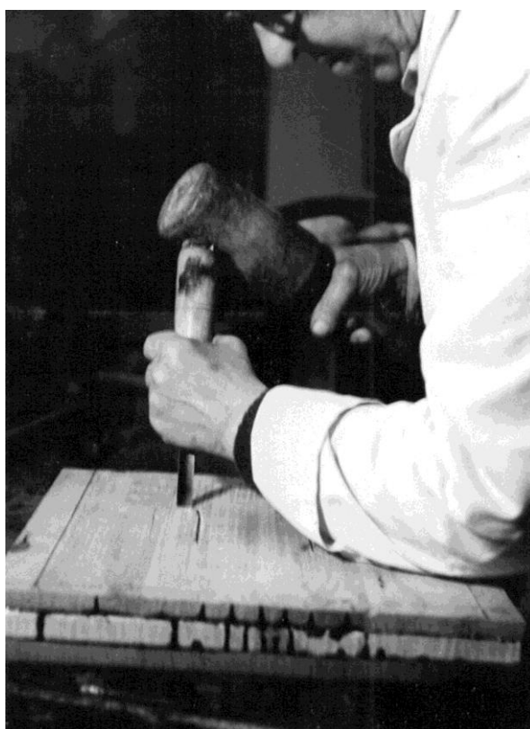
Obrázek 38 – Dochovaný postup výroby formy podle Josefa Vlka. Tři vrstvy slepených dřevěných desek, do kterých se vydlabávají grify. 743
