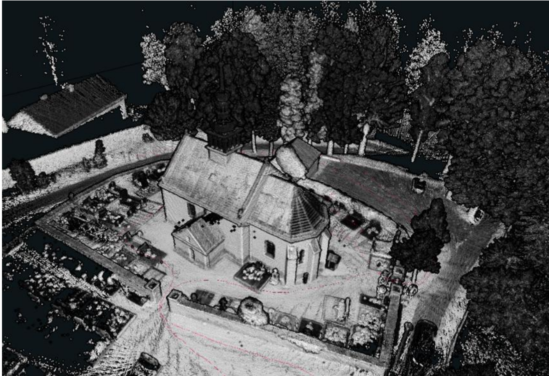
Model kostela sv. Mikuláše z mračna bodů v programu GeoSLAM Hub.
