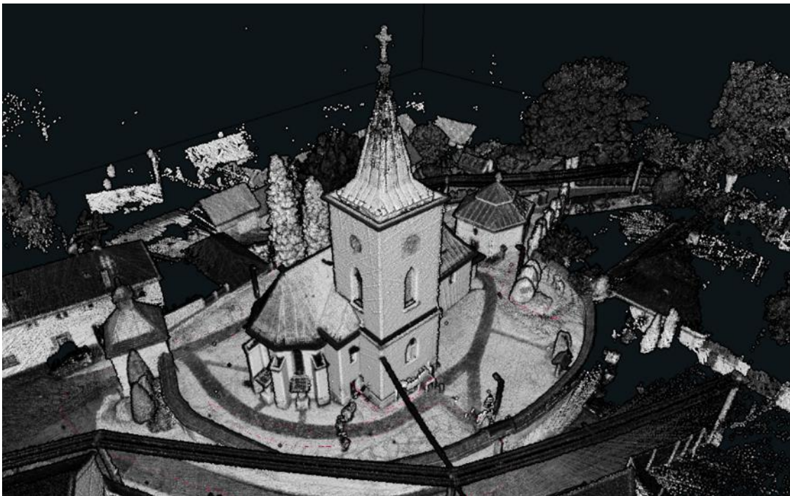
Model kostela sv. Jakuba z mračna bodů v programu GeoSLAM Hub.
