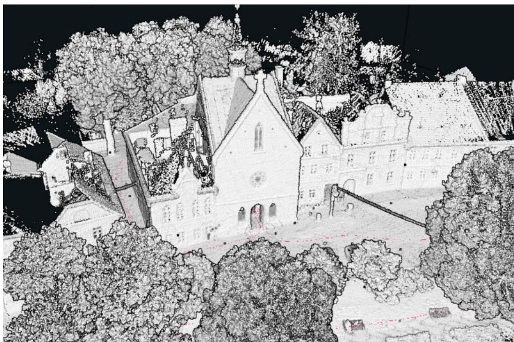
Model kostela sv. Anny z mračna bodů v programu GeoSLAM Hub.
