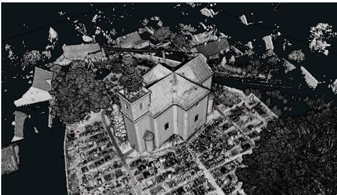
Model kostela sv. Barbory z mračna bodů v programu GeoSLAM Hub.
