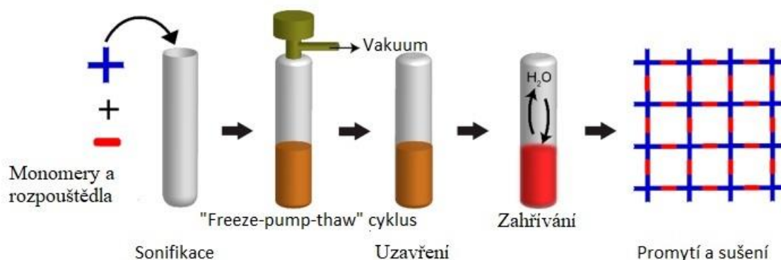
Obrázek 4: Solvotermální metoda přípravy COFs vedená v zatavitelné skleněné trubici. [16]
