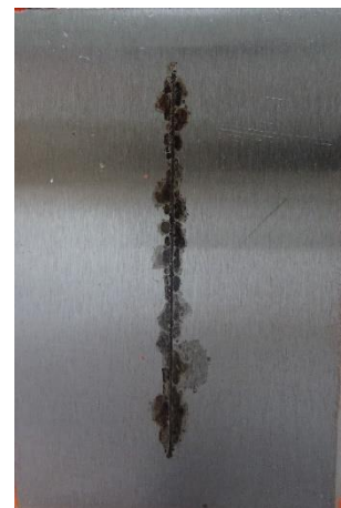
Epoxyesterový povlak pigmentovaný \text{Pb}_3\text{O}_4 před expozicí, po expozici 1440 h, po odstranění nátěrového filmu
