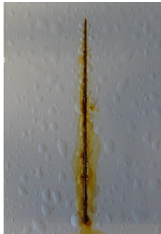
Epoxidový povlak pigmentovaný \text{TiO}_2 před expozicí, po expozici 1440 h, po odstranění nátěrového filmu
