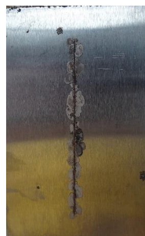
Alkydový povlak pigmentovaný \text{Zn}_3(\text{PO}_4)_2 před expozicí, po expozici 1440 h, po odstranění nátěrového filmu
