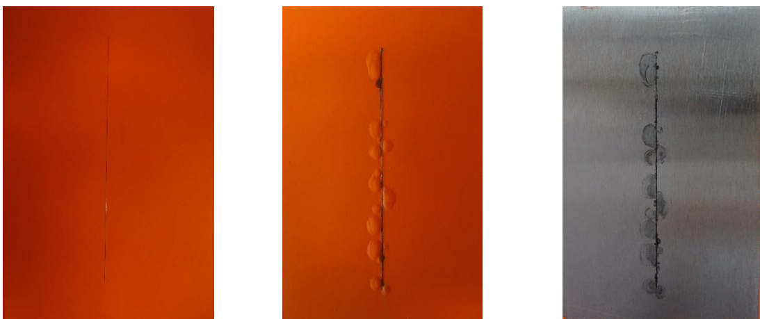
Epoxyesterový povlak pigmentovaný Pb_3O_4 před expozicí, po expozici 1440 h, po odstranění nátěrového filmu
