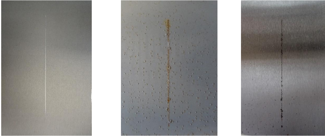
Epoxyesterový povlak pigmentovaný \text{Mg}_3[(\text{OH})_2(\text{Si}_4\text{O}_{10})] před expozicí, po expozici 1440 h, po odstranění povlaku
