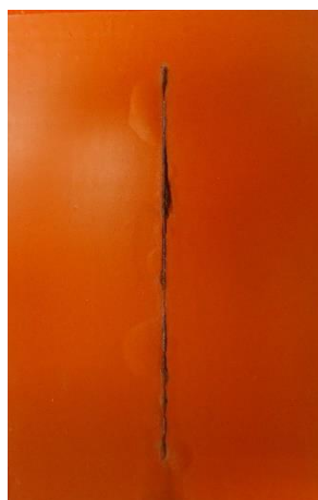
Epoxidový povlak pigmentovaný \text{Pb}_3\text{O}_4 před expozicí, po expozici 1440 h, po odstranění nátěrového filmu
