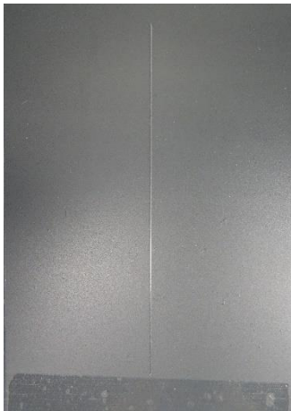
Alkydový povlak pigmentovaný Zn před expozicí, po expozici 1440 h, po odstranění nátěrového filmu
