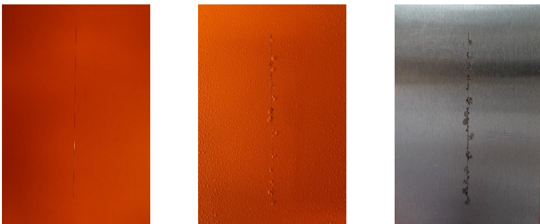
Epoxyesterový povlak pigmentovaný \text{Pb}_3\text{O}_4 před expozicí, po expozici 1440 h, po odstranění nátěrového filmu
