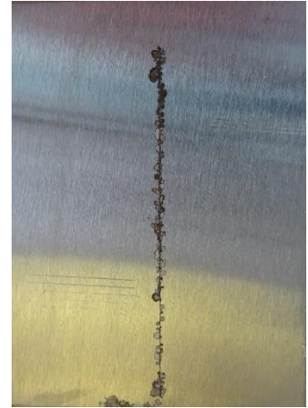
Alkydový povlak pigmentovaný Mg_3[(OH)_2(Si_4O_{10})] před expozicí, po expozici 1440 h, po odstranění povlaku
