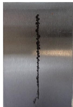
Epoxyesterový povlak pigmentovaný Zn 3 (PO 4 ) 2 před expozicí, po expozici 1440 h, po odstranění nátěrového filmu
