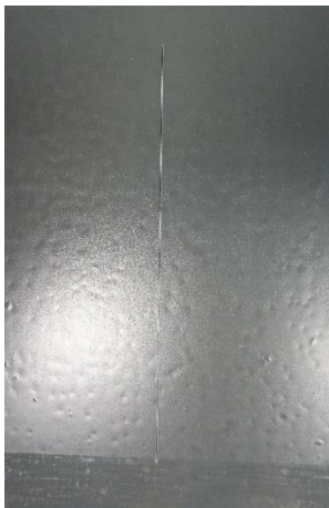
Epoxidový povlak pigmentovaný Zn před expozicí, po expozici 1440 h, po odstranění nátěrového filmu
