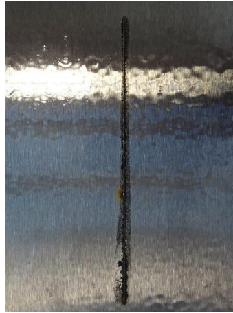
Nepigmentovaný epoxidový povlak před expozicí, po expozici 1440 h, po odstranění povlaku
