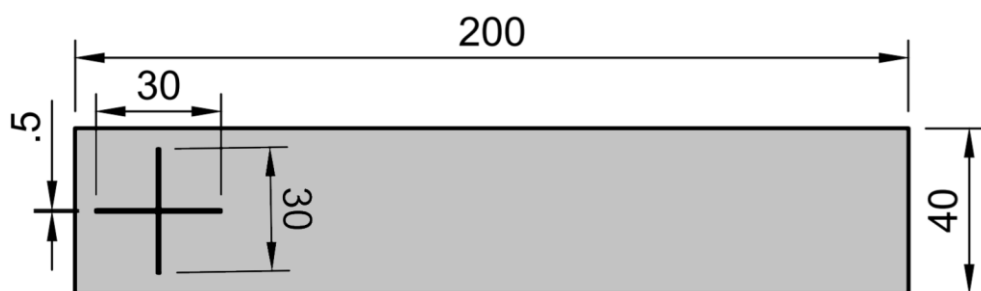
Obrázek 5: Nákres křížového řezu pro mechanické zkoušky.
