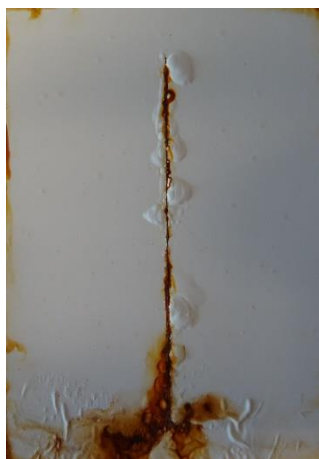
Alkydový povlak pigmentovaný \text{TiO}_2 před expozicí, po expozici 1440 h, po odstranění nátěrového filmu
