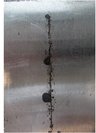
Nepigmentovaný epoxyesterový povlak před expozicí, po expozici 1440 h, po odstranění povlaku
