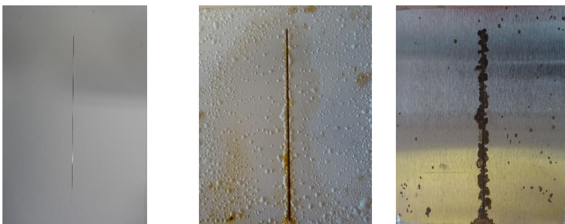
Alkydový povlak pigmentovaný \text{TiO}_2 před expozicí, po expozici 1440 h, po odstranění nátěrového filmu
