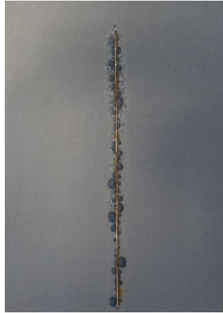
Epoxidový povlak pigmentovaný \text{Mg}_3[(\text{OH})_2(\text{Si}_4\text{O}_{10})] před expozicí, po expozici 1440 h, po odstranění povlaku
