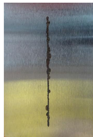
Alkydový povlak pigmentovaný Pb_3O_4 před expozicí, po expozici 1440 h, po odstranění nátěrového filmu
