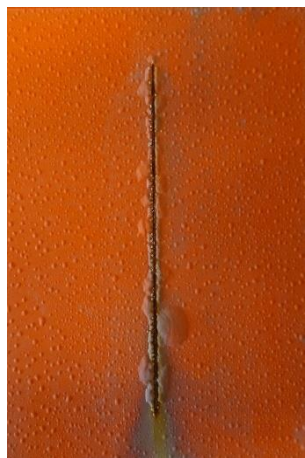
Epoxyesterový povlak pigmentovaný \text{Pb}_3\text{O}_4 před expozicí, po expozici 1440 h, po odstranění nátěrového filmu
