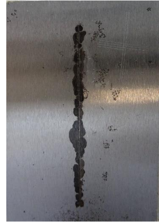
Epoxyesterový povlak pigmentovaný \text{Mg}_3[(\text{OH})_2(\text{Si}_4\text{O}_{10})] před expozicí, po expozici 1440 h, po odstranění povlaku
