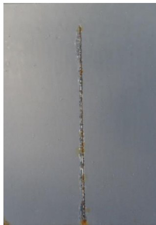
Epoxidový povlak pigmentovaný Zn 3 (PO 4 ) 2 před expozicí, po expozici 1440 h, po odstranění nátěrového filmu
