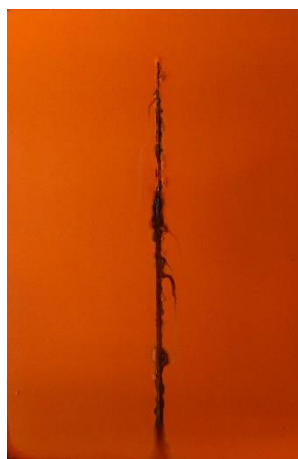
Alkydový povlak pigmentovaný Pb_3O_4 před expozicí, po expozici 1440 h, po odstranění nátěrového filmu
