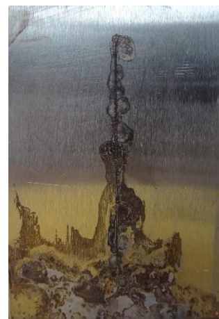
Alkydový povlak pigmentovaný \text{TiO}_2 před expozicí, po expozici 1440 h, po odstranění nátěrového filmu
