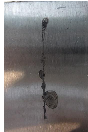
Epoxyesterový povlak pigmentovaný \text{TiO}_2 před expozicí, po expozici 1440 h, po odstranění nátěrového filmu
