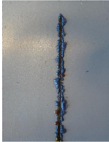
Nepigmentovaný epoxyesterový povlak před expozicí, po expozici 1440 h, po odstranění povlaku
