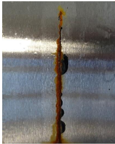
Nepigmentovaný epoxidový povlak před expozicí, po expozici 1440 h, po odstranění povlaku
