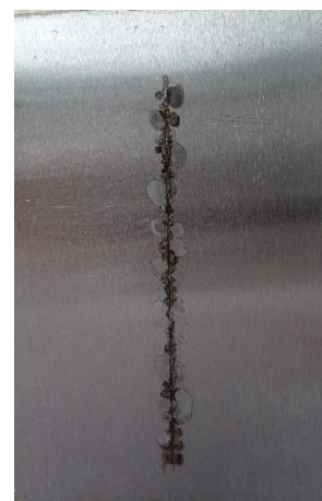
Epoxyesterový povlak pigmentovaný \text{Zn}_3(\text{PO}_4)_2 před expozicí, po expozici 1440 h, po odstranění nátěrového filmu
