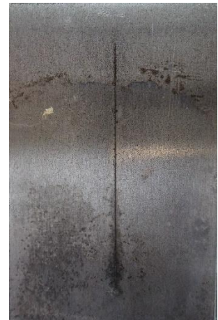
Epoxyesterový povlak pigmentovaný \text{Mg}_3[(\text{OH})_2(\text{Si}_4\text{O}_{10})] před expozicí, po expozici 1440 h, po odstranění povlaku
