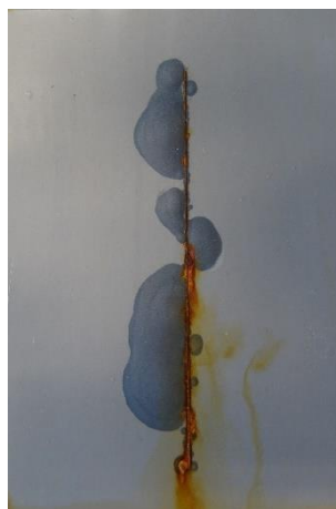
Epoxidový povlak pigmentovaný Zn 3 (PO 4 ) 2 před expozicí, po expozici 1440 h, po odstranění nátěrového filmu
