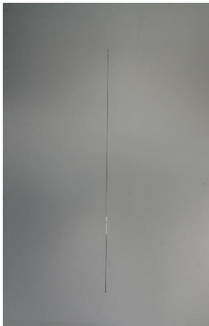
Epoxyesterový povlak pigmentovaný TiO 2 před expozicí, po expozici 1440 h, po odstranění nátěrového filmu
