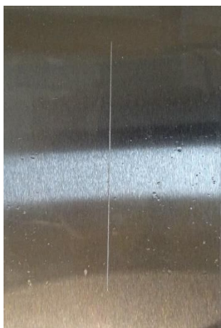
Nepigmentovaný alkydový povlak před expozicí, po expozici 1440 h, po odstranění povlaku
