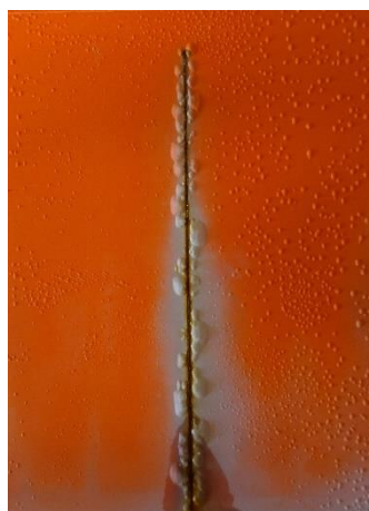
Alkydový povlak pigmentovaný Pb_3O_4 před expozicí, po expozici 1440 h, po odstranění nátěrového filmu
