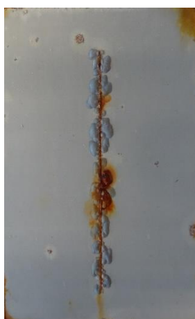
Alkydový povlak pigmentovaný \text{Zn}_3(\text{PO}_4)_2 před expozicí, po expozici 1440 h, po odstranění nátěrového filmu
