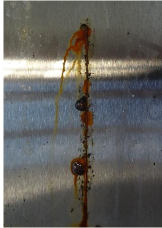
Nepigmentovaný epoxyesterový povlak před expozicí, po expozici 1440 h, po odstranění povlaku
