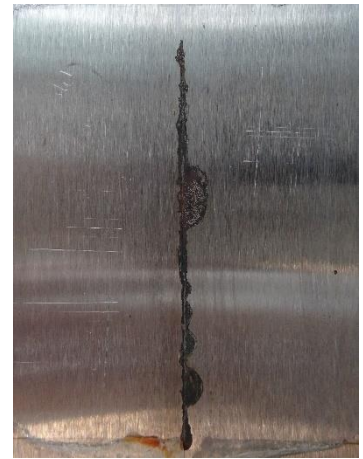
Nepigmentovaný epoxidový povlak před expozicí, po expozici 1440 h, po odstranění povlaku
