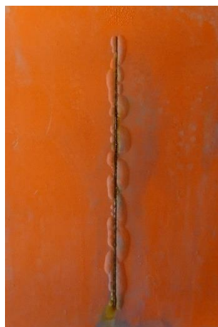
Epoxidový povlak pigmentovaný \text{Pb}_3\text{O}_4 před expozicí, po expozici 1440 h, po odstranění nátěrového filmu
