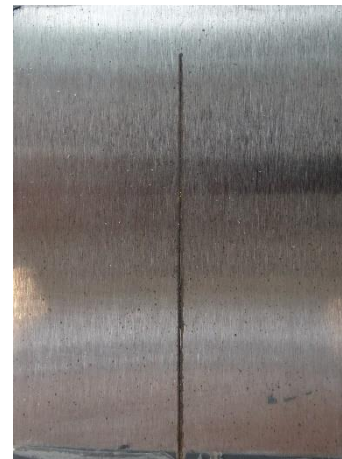
Epoxidový povlak pigmentovaný Zn před expozicí, po expozici 1440 h, po odstranění nátěrového filmu
