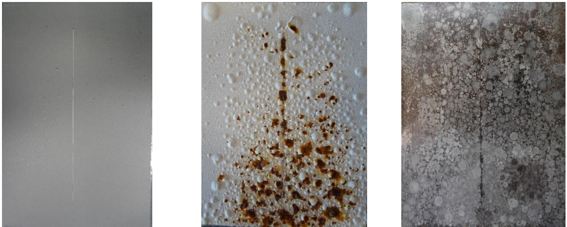
Epoxyesterový povlak pigmentovaný Zn před expozicí, po expozici 1440 h, po odstranění nátěrového filmu
