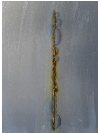
Epoxidový povlak pigmentovaný \text{Mg}_3[(\text{OH})_2(\text{Si}_4\text{O}_{10})] před expozicí, po expozici 1440 h, po odstranění povlaku
