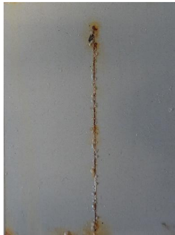
Alkydový povlak pigmentovaný Zn před expozicí, po expozici 1440 h, po odstranění nátěrového filmu
