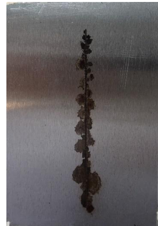
Epoxyesterový povlak pigmentovaný TiO 2 před expozicí, po expozici 1440 h, po odstranění nátěrového filmu
