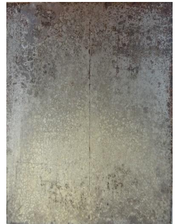
Alkydový povlak pigmentovaný Zn před expozicí, po expozici 1440 h, po odstranění nátěrového filmu
