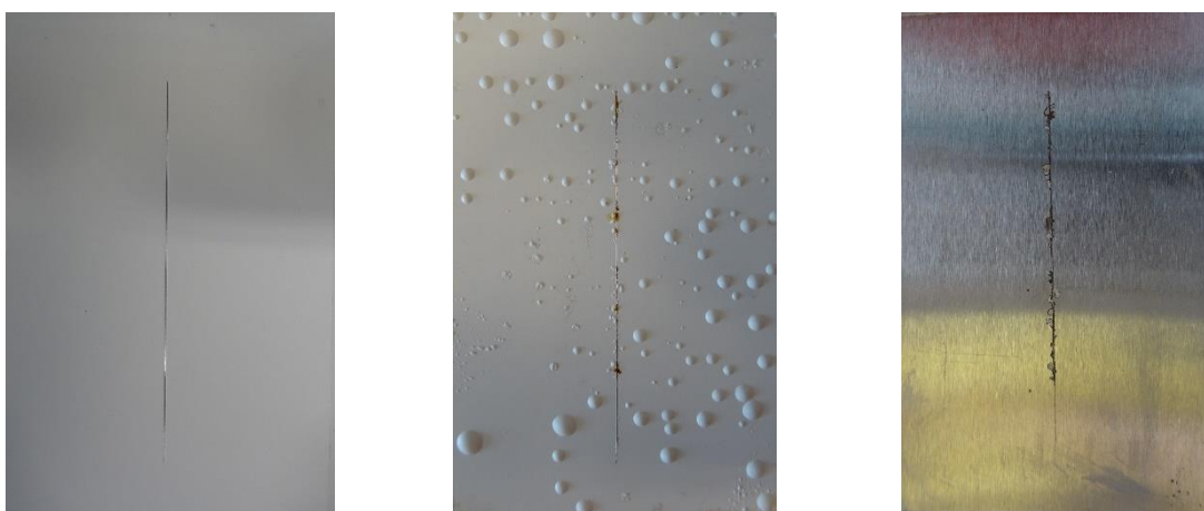
Alkydový povlak pigmentovaný \text{TiO}_2 před expozicí, po expozici 1440 h, po odstranění nátěrového filmu
