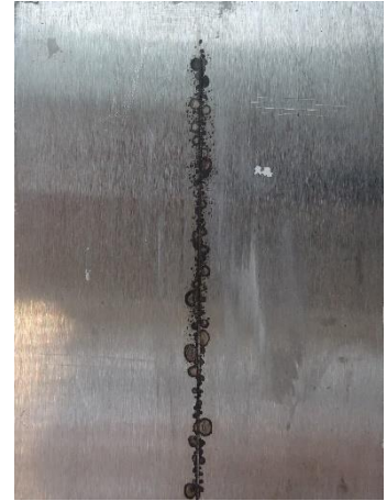
Epoxidový povlak pigmentovaný \text{Mg}_3[(\text{OH})_2(\text{Si}_4\text{O}_{10})] před expozicí, po expozici 1440 h, po odstranění povlaku
