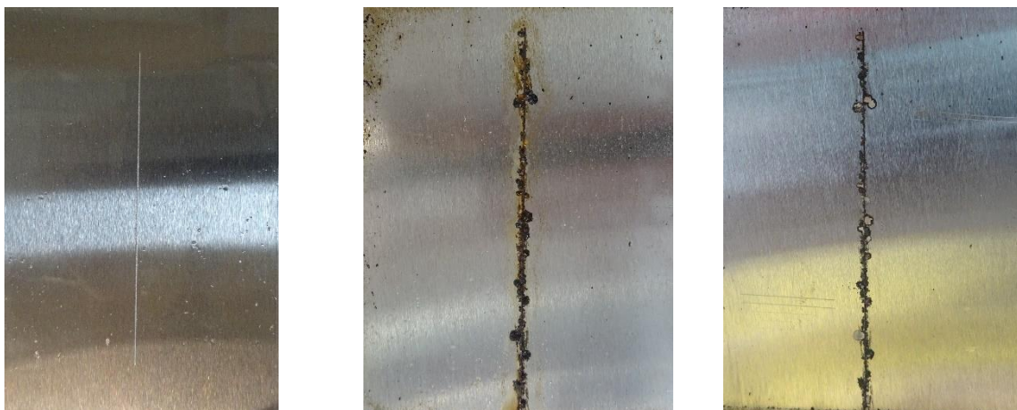
Nepigmentovaný alkydový povlak před expozicí, po expozici 1440 h, po odstranění povlaku
