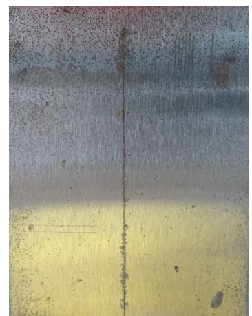
Alkydový povlak pigmentovaný Pb_3O_4 před expozicí, po expozici 1440 h, po odstranění nátěrového filmu
