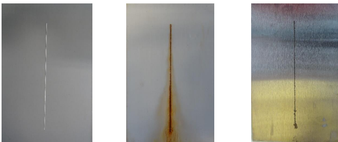
Alkydový povlak pigmentovaný \text{Zn}_3(\text{PO}_4)_2 před expozicí, po expozici 1440 h, po odstranění nátěrového filmu
