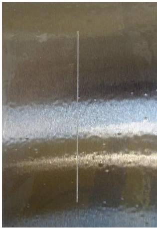
Nepigmentovaný epoxidový povlak před expozicí, po expozici 1440 h, po odstranění povlaku
