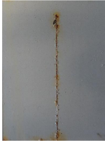
Alkydový povlak pigmentovaný Mg_3[(OH)_2(Si_4O_{10})] před expozicí, po expozici 1440 h, po odstranění povlaku
