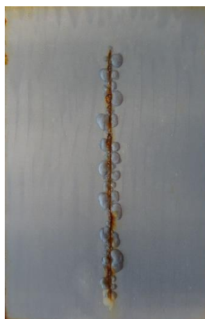
Epoxyesterový povlak pigmentovaný \text{Zn}_3(\text{PO}_4)_2 před expozicí, po expozici 1440 h, po odstranění nátěrového filmu
