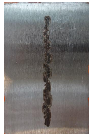
Epoxidový povlak pigmentovaný \text{Pb}_3\text{O}_4 před expozicí, po expozici 1440 h, po odstranění nátěrového filmu
