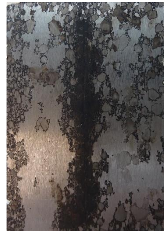
Epoxidový povlak pigmentovaný \text{TiO}_2 před expozicí, po expozici 1440 h, po odstranění nátěrového filmu
