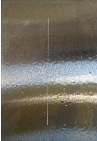
Nepigmentovaný epoxidový povlak před expozicí, po expozici 1440 h, po odstranění povlaku
