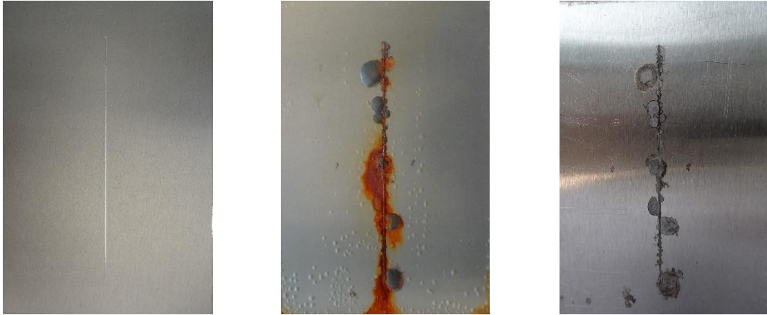
Epoxyesterový povlak pigmentovaný Mg_3[(OH)_2(Si_4O_{10})] před expozicí, po expozici 1440 h, po odstranění povlaku
