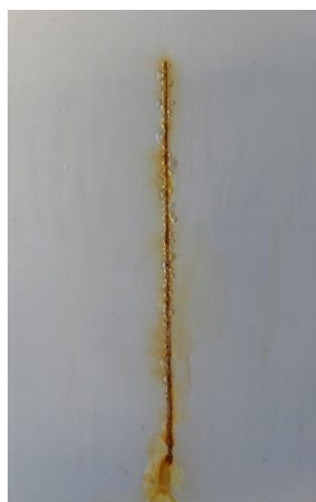
Epoxyesterový povlak pigmentovaný Zn 3 (PO 4 ) 2 před expozicí, po expozici 1440 h, po odstranění nátěrového filmu
