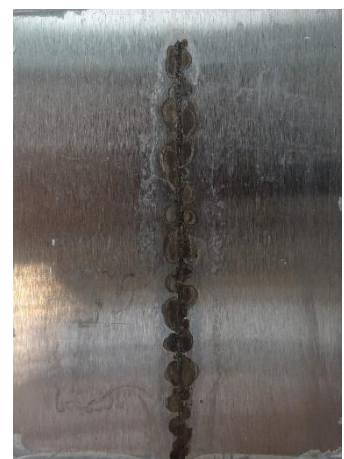
Epoxidový povlak pigmentovaný \text{Zn}_3(\text{PO}_4)_2 před expozicí, po expozici 1440 h, po odstranění nátěrového filmu
