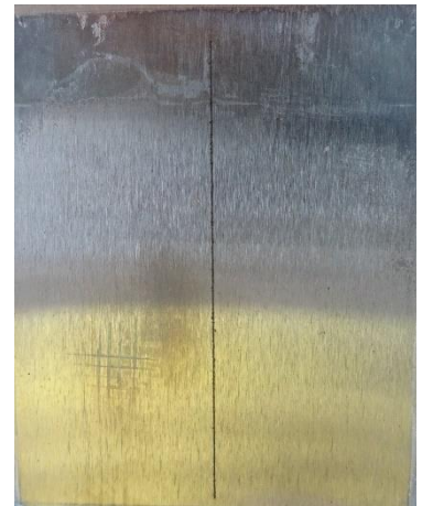
Alkydový povlak pigmentovaný Zn před expozicí, po expozici 1440 h, po odstranění nátěrového filmu
