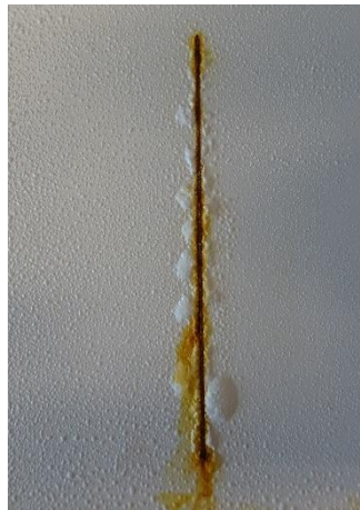
Epoxyesterový povlak pigmentovaný TiO 2 před expozicí, po expozici 1440 h, po odstranění nátěrového filmu
