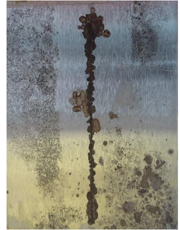
Alkydový povlak pigmentovaný Mg_3[(OH)_2(Si_4O_{10})] před expozicí, po expozici 1440 h, po odstranění povlaku
