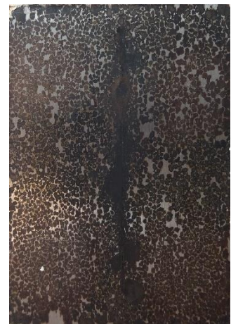
Epoxidový povlak pigmentovaný TiO 2 před expozicí, po expozici 1440 h, po odstranění nátěrového filmu
