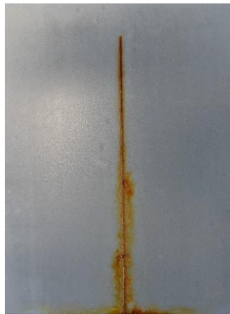
Epoxidový povlak pigmentovaný Zn před expozicí, po expozici 1440 h, po odstranění nátěrového filmu
