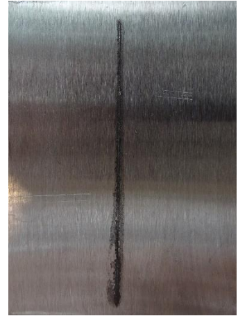
Nepigmentovaný epoxidový povlak před expozicí, po expozici 1440 h, po odstranění povlaku
