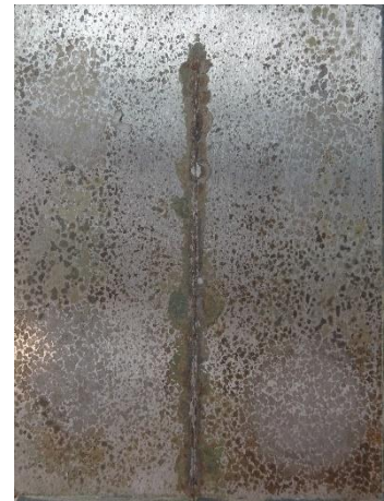
Epoxidový povlak pigmentovaný Zn před expozicí, po expozici 1440 h, po odstranění nátěrového filmu
