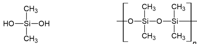
Obrázek 2: Strukturní vzorce silanolu a polysiloxanu.
