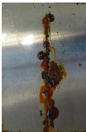
Nepigmentovaný alkydový povlak před expozicí, po expozici 1440 h, po odstranění povlaku
