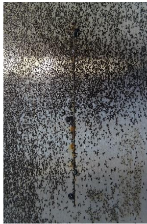
Nepigmentovaný epoxyesterový povlak před expozicí, po expozici 1440 h, po odstranění povlaku
