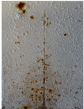
Alkydový povlak pigmentovaný Zn před expozicí, po expozici 1440 h, po odstranění nátěrového filmu
