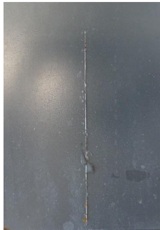
Epoxidový povlak pigmentovaný Zn před expozicí, po expozici 1440 h, po odstranění nátěrového filmu
