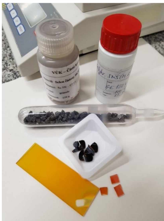
Obrázek 16 - Navážka prvků v zatavené křemenné ampuli a syntetizované sklo \text{Ge}_{25}\text{Se}_{75} ve formě objemového vzorku a napařených tenkých vrstev
