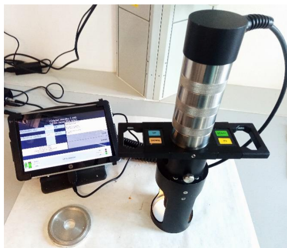
Obr. 20 – Elcometer 106 s vyhodnocovacím softwarom a vonkajším kolieskom.
