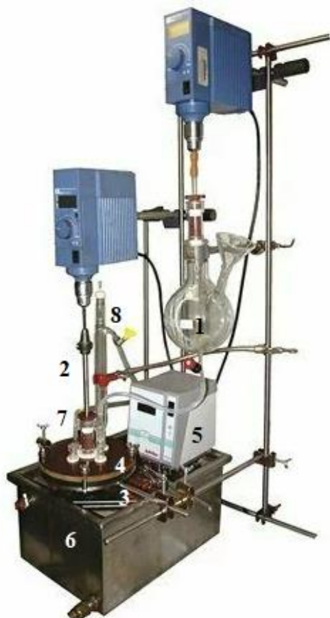
Obr. 9 – Aparatúra k emulznej polymerácii. Prevziate z: (Machotová 2016).
