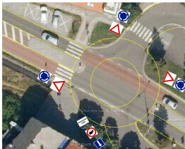
Obrázek 37: Návrh napojení silnice III/3424 na silnici I/17
