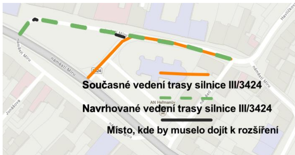
Obrázek 33: Návrh nového vedení trasy silnice III/3424
