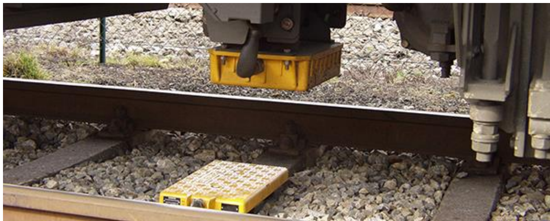
Obrázek 4 - přenosový modul balízy na spodku vozidla
