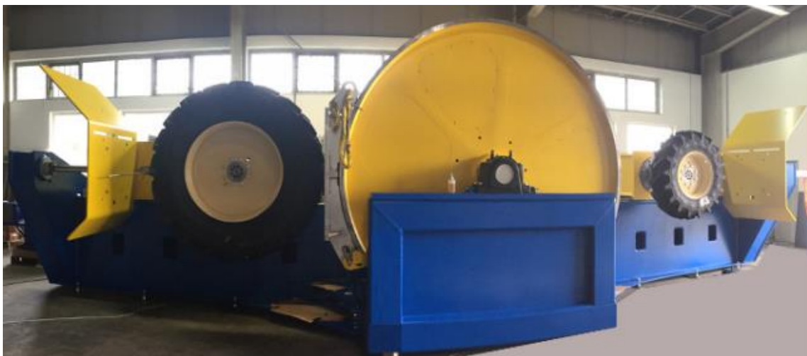
Obr. 4 – Válcová zkušebna Altracon pro zemědělské stroje [5]
