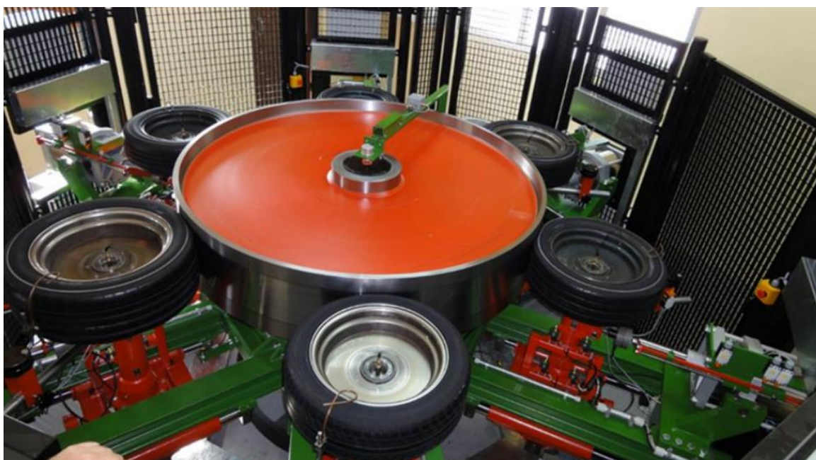
Obr. 3 – Válcová zkušebna Altracon se šesti pozicemi [5]
