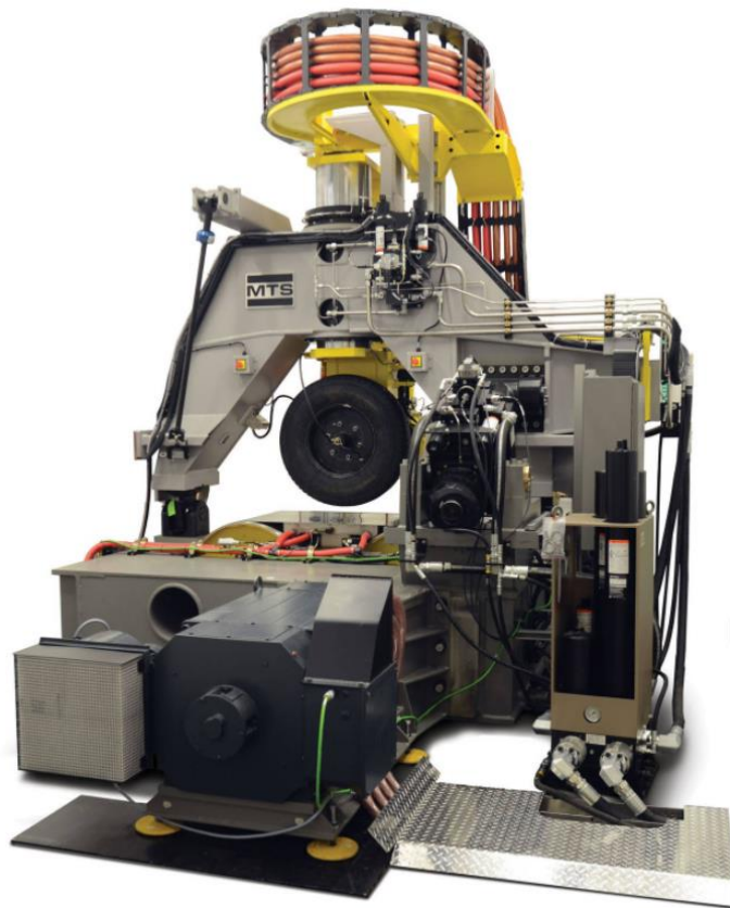
Obr. 8 – Systém pro měření sil a momentů Flat-Trac MTS [11]
