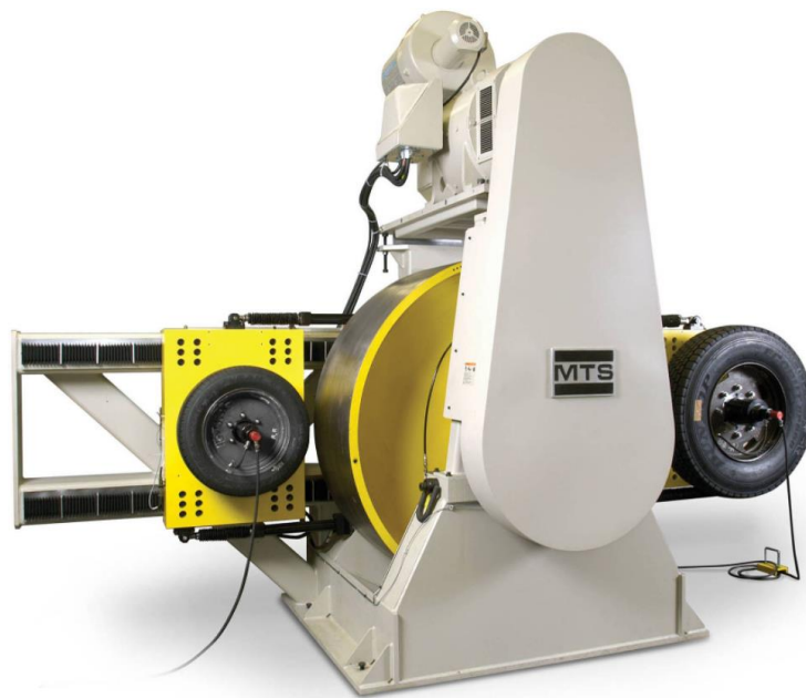
Obr. 9 – Válcová zkušebna valivého odporu MTS [12]
