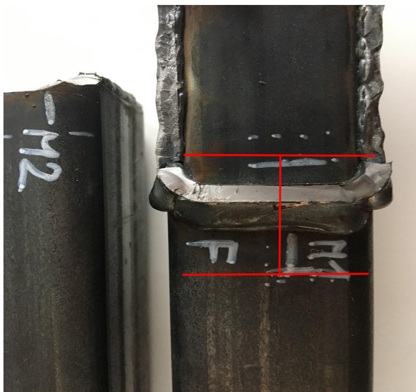
Obrázek 19 Naznačení provedení řezů vzorku B1.
