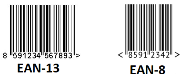
Obrázek 3 Formáty kódu EAN – EAN–13 a EAN–8 (Sixta a Mačát, 2005)
