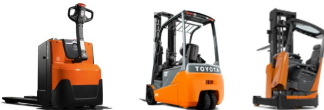
Obrázek 6 Ukázka manipulační techniky (zleva) Elektrický paletový vozík BT Levio 1,6 t; Elektrický čelní vozík Toyota Traigo 48V, 1,5 t; Retrak – BT Reflex 1,4t s naklápěním kabiny (TOYOTA –FORKLIFTS, 2020)
