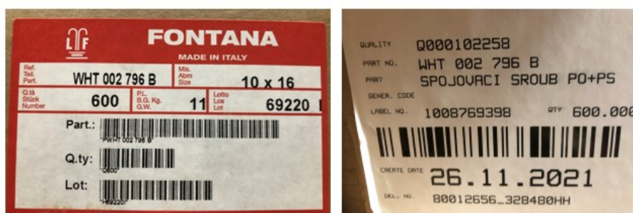
Obrázek 2 Ukázka čárového kódu jednoho téhož dílu WHT 002 796 B, vlevo značení od výrobce – dodavatele, vpravo štítek ze systému DCI společnosti AIMTEC (autorka)
