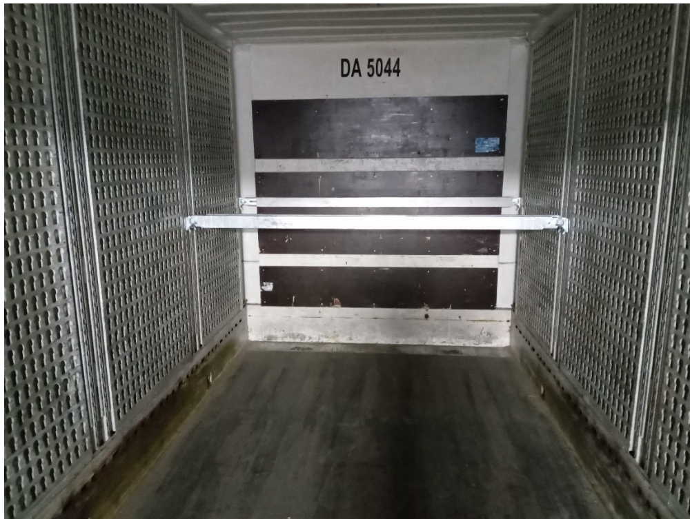
Obrázek 8 Vnitřní prostor vexlbricku s připraveným patrem (autor)
