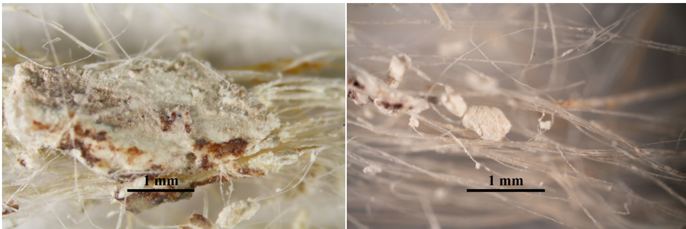
Obr. 59: Makrosnímek vzorku V22 (10178) z lícové strany vzorku (vlevo) a detail vláken (vpravo). Snímek v odraženém bílém světle ze stereomikroskopu SMZ800 (Nikon) při zvětšení na mikroskopu 2x a 5x.
