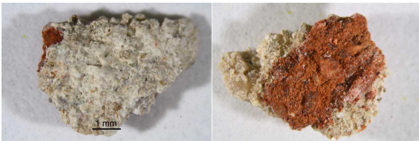
Obr. 24 a, b: Makrosnímek vzorku V7 (10032) z lícové (a) a rubové strany (b) vzorku. Snímek v odraženém bílém světle ze stereomikroskopu SMZ800 (Nikon) při zvětšení na mikroskopu 1,5x. Červená vrstva je cihlový podklad.
