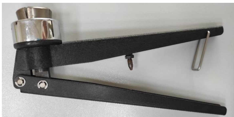
Obrázek 15 – Ruční krimpovací kleště
