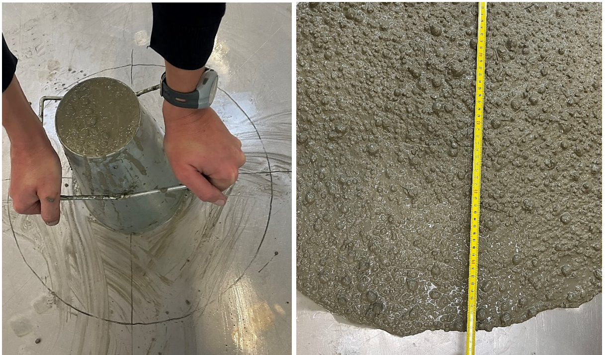
Obrázek 13: Průběh zkoušky sednutí-rozlitím [vlastní foto]
