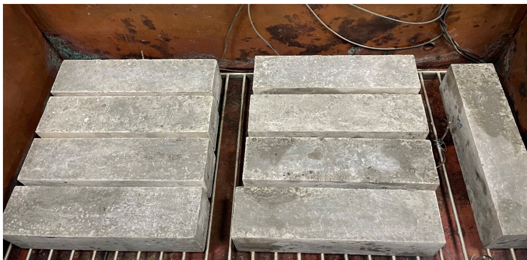
Obrázek 27: Rozložení těles v cyklovacím zařízení [vlastní foto]
