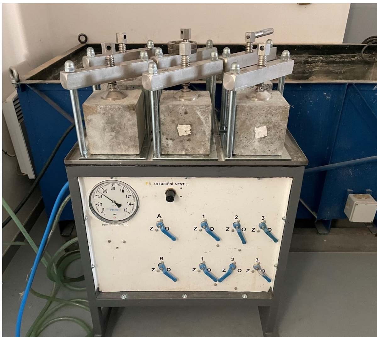
Obrázek 25: Zkušební tělesa vystavená působení vodního tlaku [vlastní foto]
