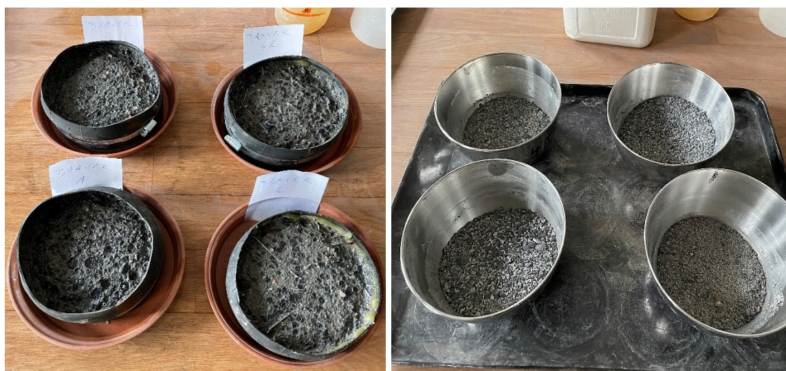
Obrázek 30: Zkušební vzorky a odpady po 25 cyklech [vlastní foto]
