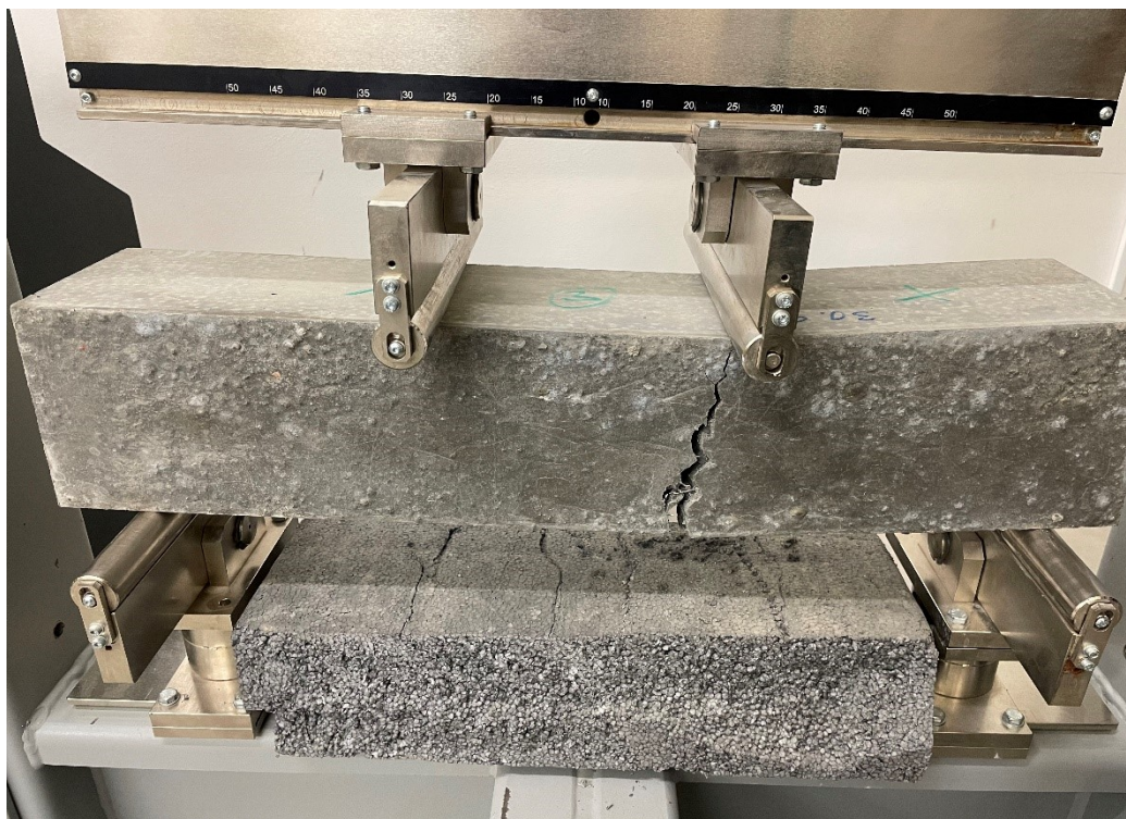
Obrázek 22: Porušené těleso při zkoušce pevnosti v tahu za ohybu [vlastní foto]
