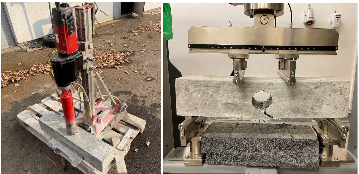
Obrázek 24: Jádrové vrtání (vlevo) a porušené těleso (vpravo) [vlastní foto]
