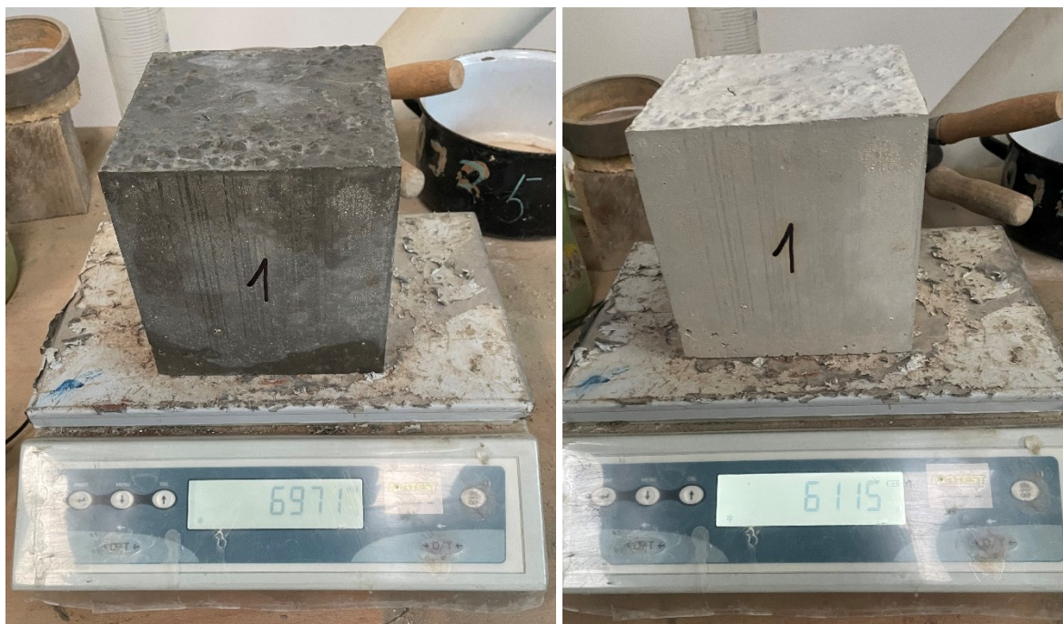
Obrázek 19: Hmotnost po nasycení (vlevo) a hmotnost po vysušení (vpravo) [vlastní foto]
