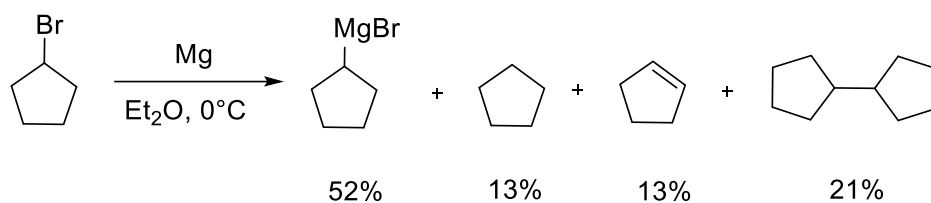
Schéma 19 Směs produktů během syntézy cyklopentylmagneziumbromidu [14].
