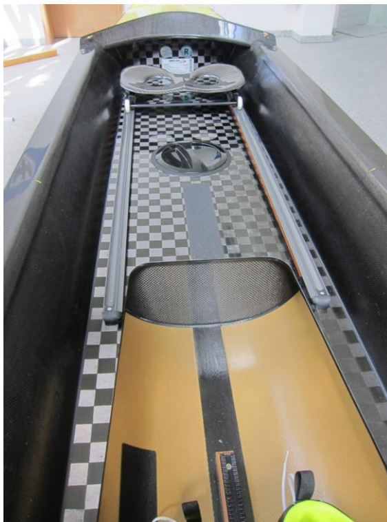
Obrázek 5: Karbonovo – kevlarová struktura veslařské lodi. [12]
