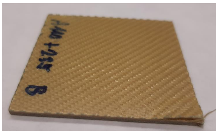
Obrázek 43: Delaminace vzorku s kevlarovou výztuží po zkoušce nasákavosti ve vodě.
