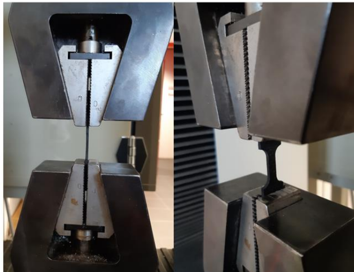
Obrázek 37: Vzorek ve tvaru "psí kosti" upevněný v čelistech trhacího stroje.
