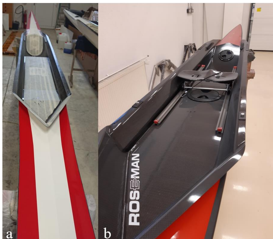
Obrázek 30: Fáze výroby po skončení laminace: a – spojení palub s obšívkou; b – hotová loď po finální kompletaci.
