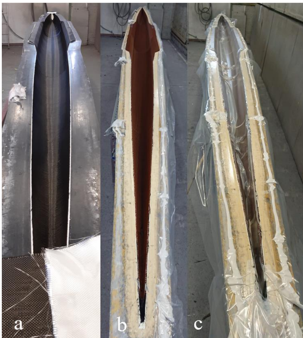
Obrázek 28: První fáze laminace: a – prosycená uhlíková tkanina; b – vrstva nomexové voštiny; c – vyztužující vrstvy pod krycí fólií po odsátí.
