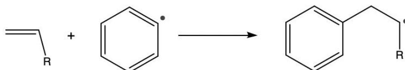
Schéma 16: Fenylový radikál se aduje na nenasycený monomer, nositelem aktivního centra je nyní monomer; tímto procesem začíná propagační krok
