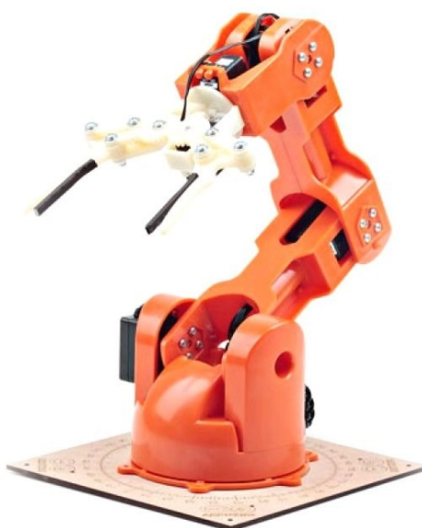
Obrázek 2.1 – Robotické rameno Braccio Tinkerkit (Botland, 2019)
