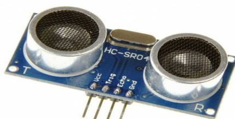
Obr. 2.4 – Ultrazvukový senzor HCSR04 (HADEX nedatováno)
