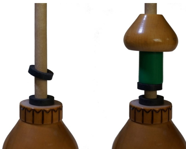
Obr. 1.2 – Magnetická levitace dvou magnetů na tyči (Ryska, 2017)
