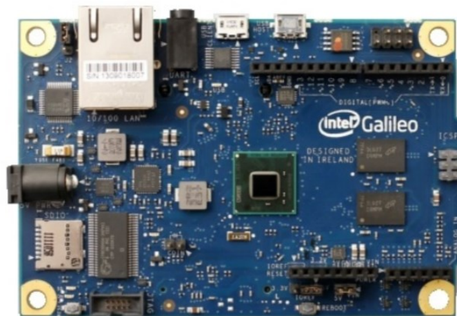
Obr. 4.1 – Zatím nejvýkonnější Arduino Galileo (Voda, 2017)
