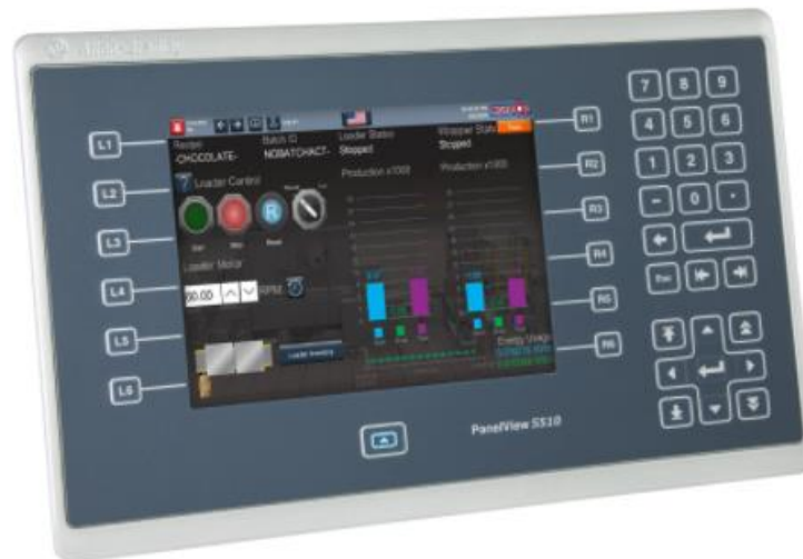
Obr. 4.1 – Ukázka HMI panelu (Rockwell Automation, nedatováno)
