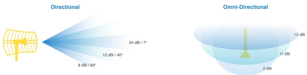
Obrázek 3 - Zobrazení zisku směrové a všesměrové antény [22]
