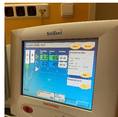
Obrázek 24 - Monitor k ovládání pumpy na kontrastní látku (Zdroj: autor)
