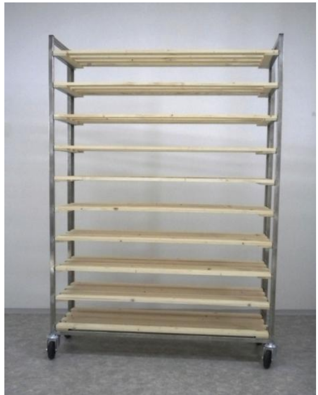
Obrázek 2.11: Vozík na plechy s těstovými kusy (vlevo), vozík na hotové výrobky (vpravo) [31].
