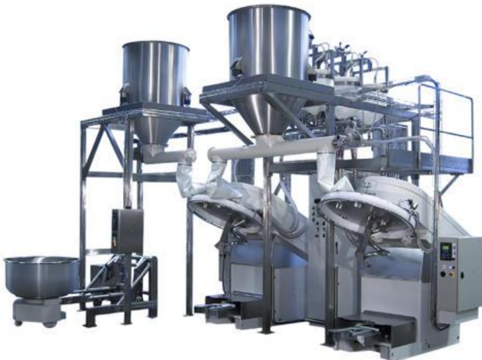
Obrázek 2.5: Dávkovací a mísící centrum v průmyslové pekárně [27].
