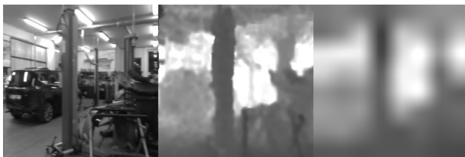
Obrázek 123: Porovnání výsledků sítě DenseNet-121. Vlevo vstupní snímek, uprostřed snímek z hloubkové kamery, vpravo výstup ze sítě DenseNet (Zdroj: Vlastní)
