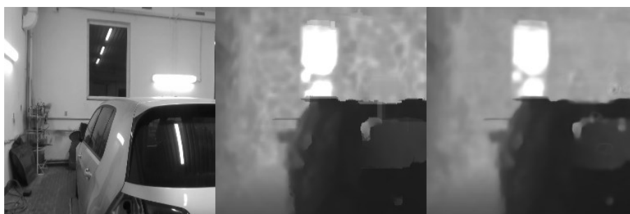
Obrázek 87: Ukázka výsledku učení neuronové sítě PSPNet. Vlevo po první epoše učení, druhý zleva po čtyřech epochách učení, třetí zleva po 9 epochách učení, vpravo skutečný snímek z hloubkové kamery (Zdroj: Vlastní)
