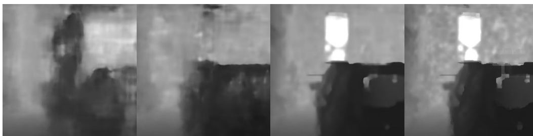
Obrázek 98: Ukázka výsledku učení neuronové sítě FCN. Vlevo po první epoše učení, druhý zleva po čtyřech epochách učení, třetí zleva po 9 epochách učení, vpravo skutečný snímek z hloubkové kamery (Zdroj: Vlastní)
