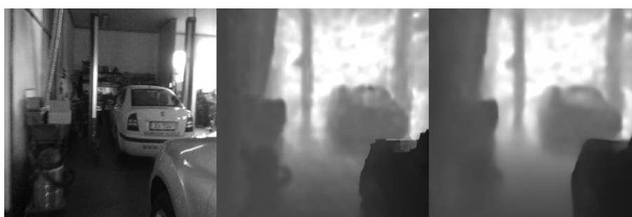
Obrázek 110: Porovnání výsledků sítě U-Net3. Vlevo vstupní snímek, uprostřed snímek z hloubkové kamery, vpravo výstup ze sítě U-Net (Zdroj: Vlastní)
