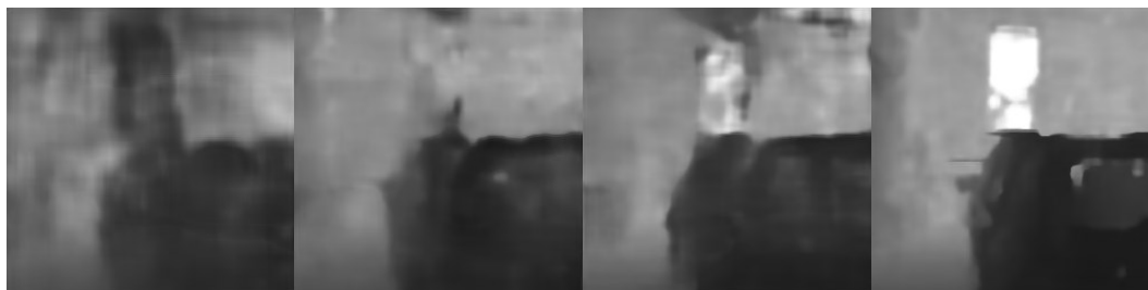
Obrázek 112: Ukázka výsledku učení neuronové sítě Xception. Vlevo po první epoše učení, druhý zleva po čtyřech epochách učení, třetí zleva po 9 epochách učení, vpravo skutečný snímek z hloubkové kamery (Zdroj: Vlastní)
