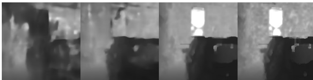
Obrázek 94: Ukázka výsledku učení neuronové sítě BiSeNet. Vlevo po první epoše učení, druhý zleva po čtyřech epochách učení, třetí zleva po 9 epochách učení, vpravo skutečný snímek z hloubkové kamery (Zdroj: Vlastní)
