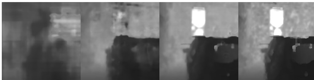
Obrázek 86: Ukázka výsledku učení neuronové sítě PSPNet. Vlevo po první epoše učení, druhý zleva po čtyřech epochách učení, třetí zleva po 9 epochách učení, vpravo skutečný snímek z hloubkové kamery (Zdroj: Vlastní)
