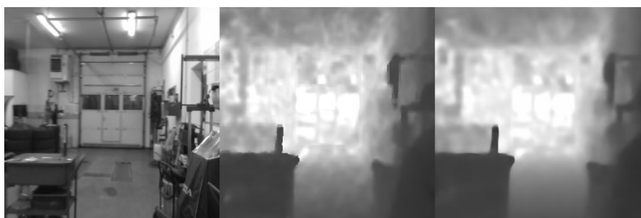
Obrázek 109: Porovnání výsledků sítě U-Net3. Vlevo vstupní snímek, uprostřed snímek z hloubkové kamery, vpravo výstup ze sítě U-Net (Zdroj: Vlastní)
