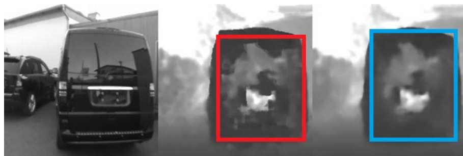
Obrázek 126: Ukázka chyb v trénovacích datech (červený rámeček) a odezva sítě (modrý rámeček). (Zdroj: Vlastní)
