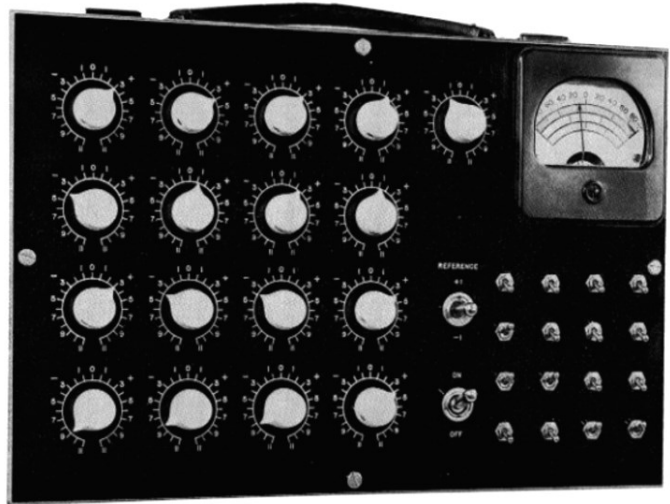
Obrázek 5: Zařízení využívající ADALINE s manuálním nastavováním vah synapsí (Widrow, 1960)
