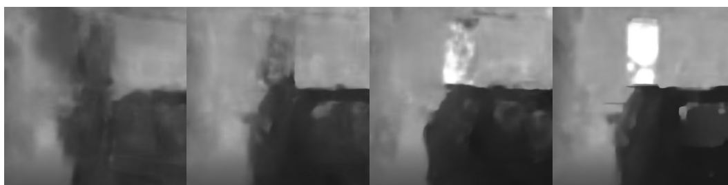
Obrázek 116: Ukázka výsledku učení neuronové sítě RefineNet. Vlevo po první epoše učení, druhý zleva po čtyřech epochách učení, třetí zleva po 9 epochách učení, vpravo skutečný snímek z hloubkové kamery (Zdroj: Vlastní)
