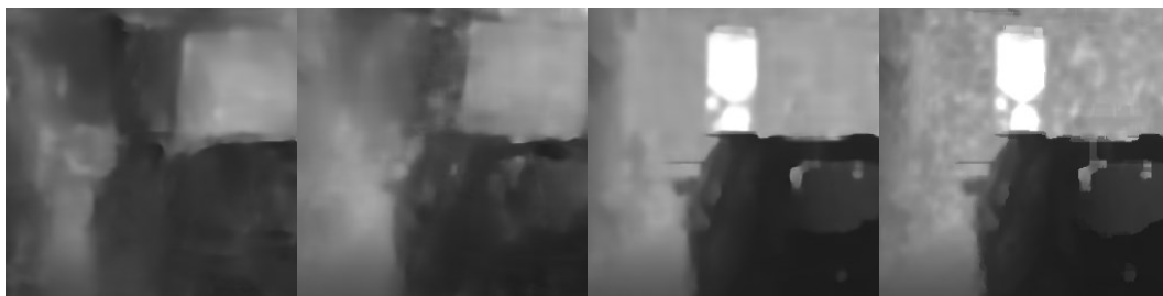
Obrázek 103: Ukázka výsledku učení neuronové sítě U-Net. Vlevo po první epoše učení, druhý zleva po čtyřech epochách učení, třetí zleva po 9 epochách učení, vpravo skutečný snímek z hloubkové kamery (Zdroj: Vlastní)
