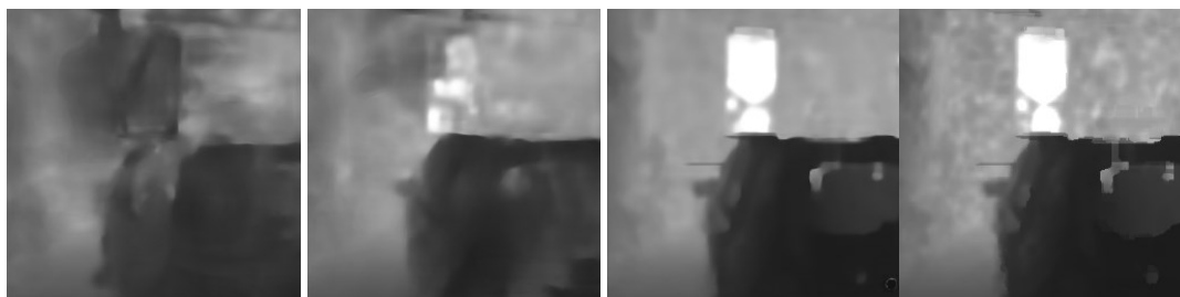
Obrázek 90: Ukázka výsledku učení neuronové sítě SegNet. Vlevo po první epoše učení, druhý zleva po čtyřech epochách učení, třetí zleva po 9 epochách učení, vpravo skutečný snímek z hloubkové kamery (Zdroj: Vlastní)
