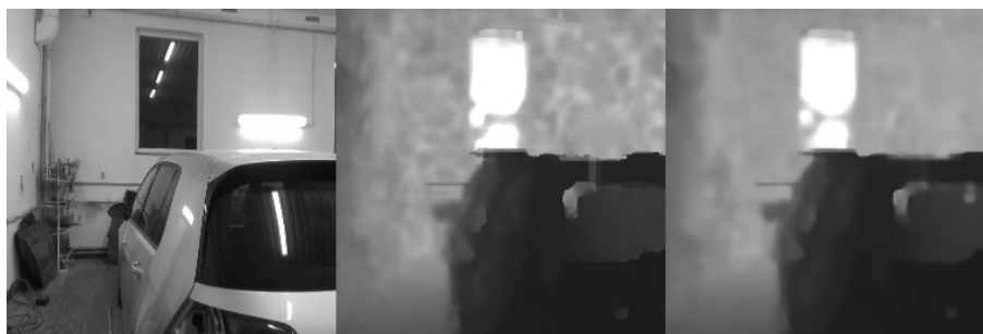
Obrázek 99: Porovnání výsledků sítě FCN. Vlevo vstupní snímek, uprostřed snímek z hloubkové kamery, vpravo výstup ze sítě FCN (Zdroj: Vlastní)
