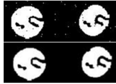
Obrázek 28: Ukázka šumu typu salt&pepper (nahore) a jeho eliminace (dole) za využití konvolučního jádra (3.12) (Zdroj: Vlastní)
