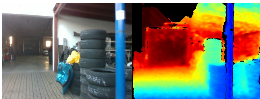
Obrázek 71 Ukázka surových snímků z hloubkové kamery – Vnitřní prostředí s umělým osvětlením. Barevný snímek (Vlevo), Hloubkový snímek (Vpravo). (Zdroj: Vlastní)
