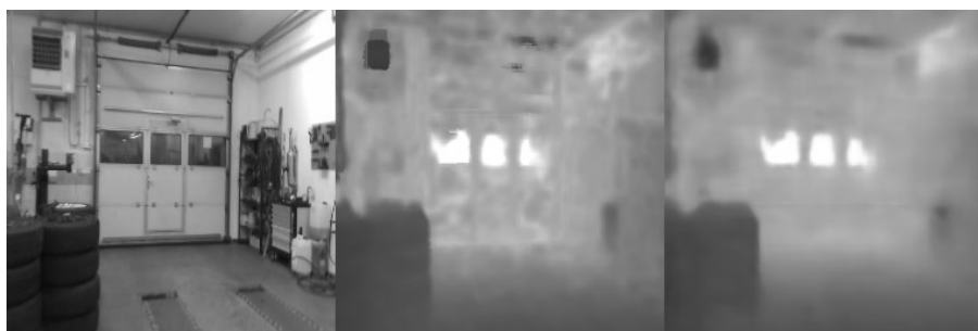
Obrázek 114: Porovnání výsledků sítě Xception. Vlevo vstupní snímek, uprostřed snímek z hloubkové kamery, vpravo výstup ze sítě Xception (Zdroj: Vlastní)
