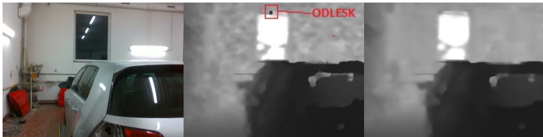
Obrázek 160: Vstupní snímky M7_2396 pro vytvoření mračka bodů. Vlevo: Snímek z barevné kamery. Uprostřed: Výstup z hloubkové kamery. Vpravo: Výstup ze sítě U-Net. (Zdroj: Vlastní)
