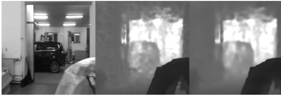
Obrázek 97: Porovnání výsledků sítě BiSeNet. Vlevo vstupní snímek, uprostřed snímek z hloubkové kamery, vpravo výstup ze sítě BiSeNet (Zdroj: Vlastní)
