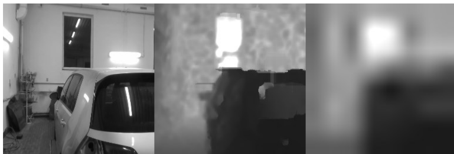
Obrázek 121: Porovnání výsledků sítě DenseNet-121. Vlevo vstupní snímek, uprostřed snímek z hloubkové kamery, vpravo výstup ze sítě DenseNet (Zdroj: Vlastní)
