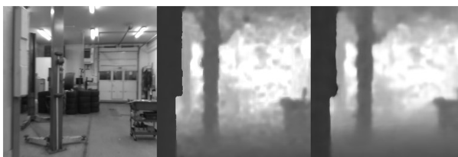
Obrázek 101: Porovnání výsledků sítě FCN. Vlevo vstupní snímek, uprostřed snímek z hloubkové kamery, vpravo výstup ze sítě FCN (Zdroj: Vlastní)
