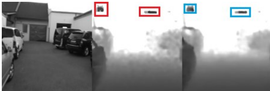
Obrázek 125: Ukázka chyb v trénovacích datech (červený rámeček) a odezva sítě (modrý rámeček). (Zdroj: Vlastní)
