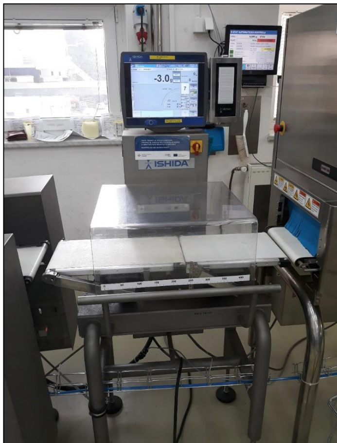
Obrázek 6: Automatická (průběžná) váha značky ISHIDA
