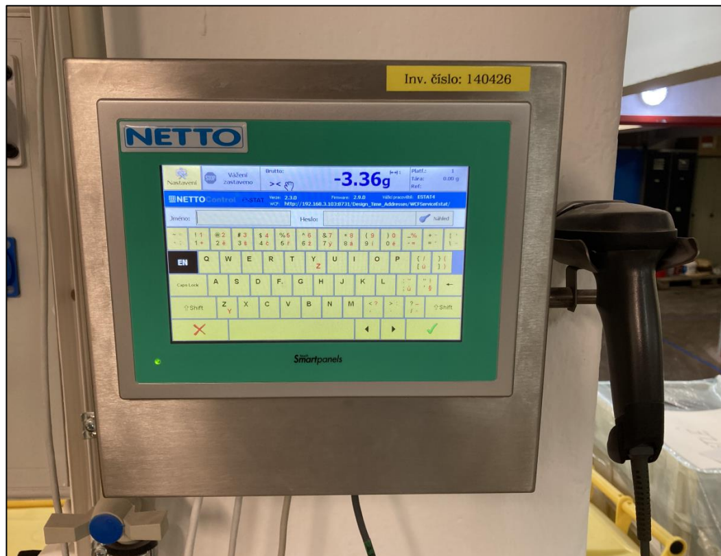
Obrázek 19: Kontrolní systém hmotnosti E-STAT u neautomatické váhy
