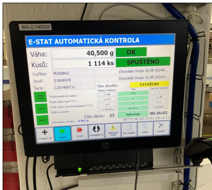
Obrázek 18: Kontrolní systém hmotnosti E-STAT u automatické váhy
