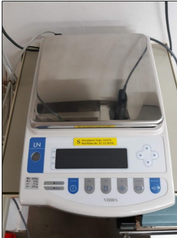
Obrázek 8: Neautomatická (statická) váha značky VIBRA
