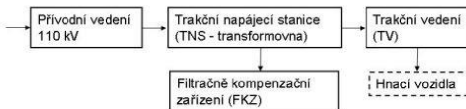
Obrázek 3 Blokové schéma soustavy 25 kV, 50 Hz AC [5]
