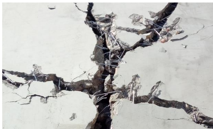
Obrázek 3. – Samozhutnitelný drátkobeton zkušební tělesa na levé, porušení na pravé straně
