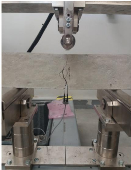
Obrázek 10. – Sestavení zatěžovacího zařízení na levé straně a uložení zatěžovaných trámců se zářezem na pravé straně
