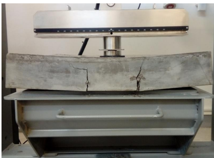
Obrázek 21. – Osazení zkušebních těles na levé straně a deformace a trhliny na pravé straně
