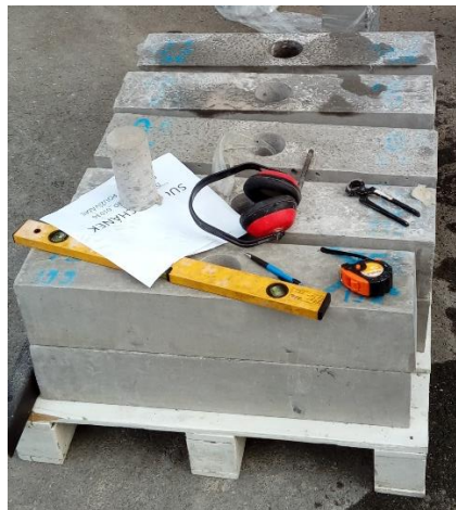
Obrázek 17. – Jádrové odvrtávání (vlevo) a odvrtané hranoly (napravo)
