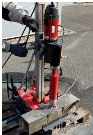
Obrázek 17. – Jádrové odvrtávání (vlevo) a odvrtané hranoly (napravo)
