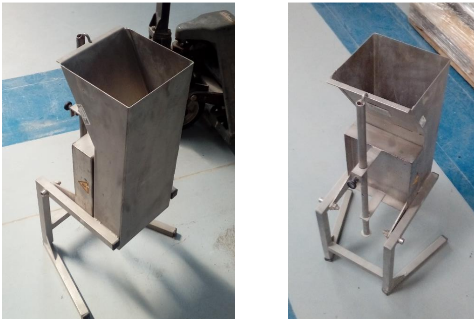
Obrázek 15. – Přípravek pro separaci kovových vláken z čerstvého betonu
