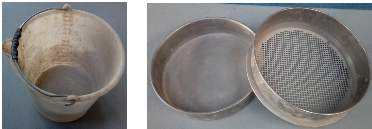
Obrázek 5. – Zkušební přípravek odolnosti proti segregaci
