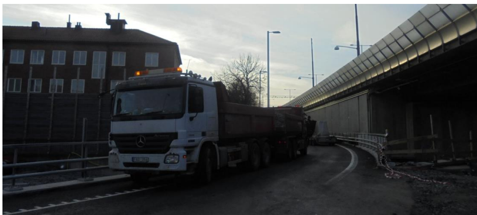
Obr. 4.14 Zatěžovací zkouška – 1. zatěžovací stav – dvě nákladní vozidla.
