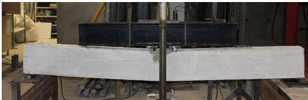
Obr. 4.40 Zkouška na čtyřbodový ohyb nosníku s dostatečnou smykovou výztuží ( EJ-C ).
