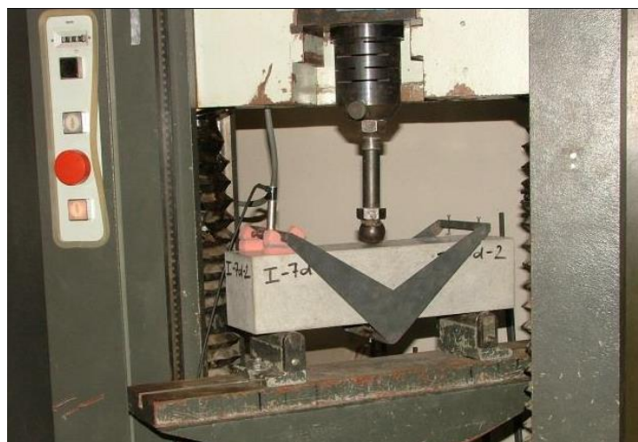
Obr. 3.9 Snímek z provádění zkoušky na tříbodový ohyb trámce se zářezem v rámci stanovování lomově-mechanických parametrů betonu C50/60.
