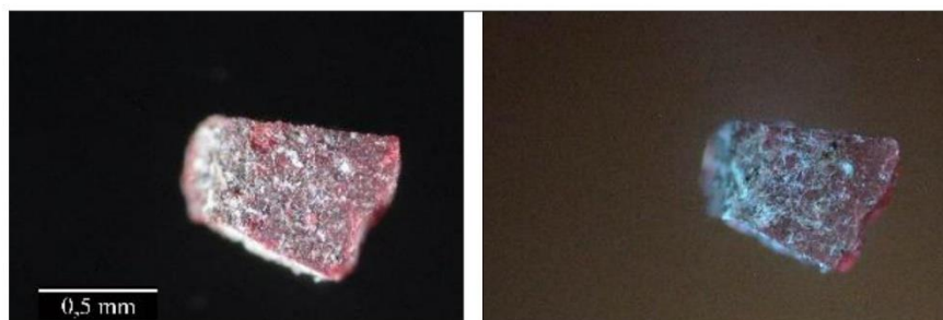
Obr. 16, 17 Optická mikroskopie, část vzorku z vrchní strany, bílé světlo, UV fluorescence.
