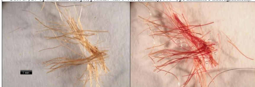
Obr. 21, 22 Optická mikroskopie, odražené světlo, před a po kontaktu s fluoroglucinem (50 ×).
