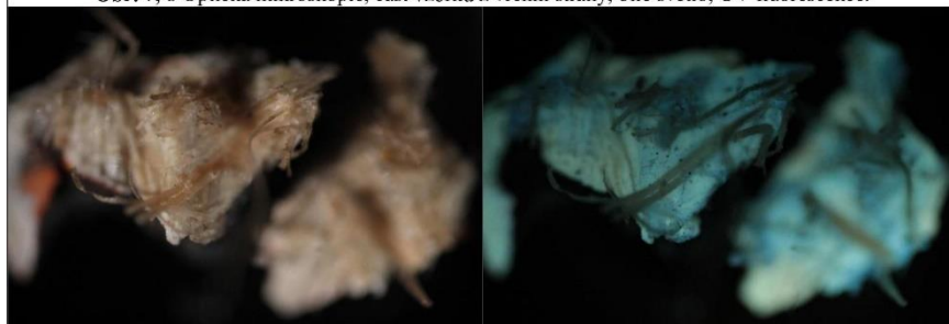
Obr. 9, 10 Optická mikroskopie, vzorek ze spodní strany, bílé světlo, UV fluorescence.
