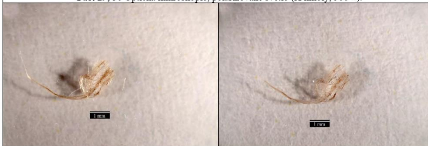
Obr. 31, 32 Optická mikroskopie, odražené světlo, před a po kontaktu s floroglucinem (50 ×).
