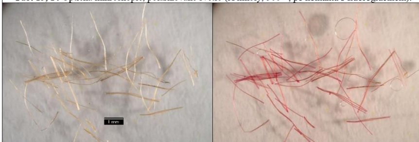
Obr. 15, 16 Optická mikroskopie, odražené světlo, před a po kontaktu s fluoroglucinem (50 ×).
