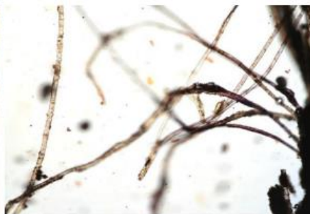
Obrázek 2 Vlákнинové složení vzorku PP_1, zvětšeno 50x, Herzbergova zkouška.
