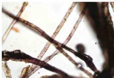
Obrázek 1 Vlákнинové složení vzorku PP_1, zvětšeno 20x, Herzbergova zkouška.
