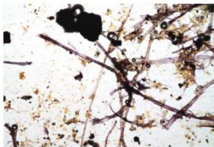
Obrázek 3 Vlákнинové složení vzorku PP_2, zvětšeno 20x, Herzbergova zkouška.
