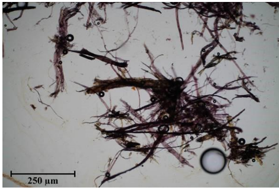
Snímky vláken vzorku 3V EP/10300 v Herzbergově činidle. Fotografováno na optickém mikroskopu Nikon ECLIPSE LV100 při zvětšení na mikroskopu 50x, 100x a 200x v bílém procházejícím světle.
