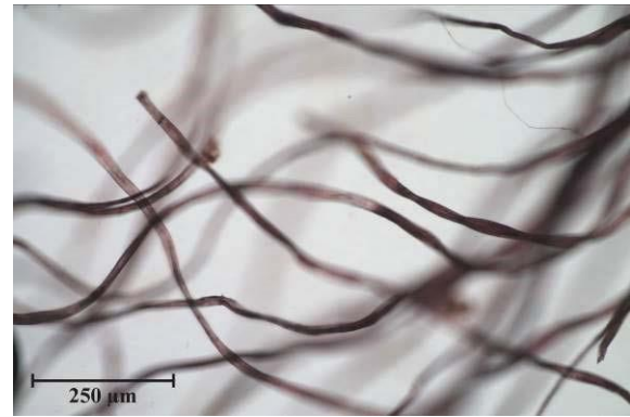
Snímky vláken vzorku 2V EP/10299 v Herzbergově činidle. Fotografováno na optickém mikroskopu Nikon ECLIPSE LV100 při zvětšení na mikroskopu 50x, 100x a 200x.v bílém procházejícím světle.
