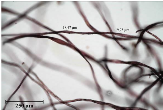
Snímky vláken vzorku 2V EP/10299 v Herzbergově činidle. Fotografováno na optickém mikroskopu Nikon ECLIPSE LV100 při zvětšení na mikroskopu 50x, 100x a 200x.v bílém procházejícím světle.
